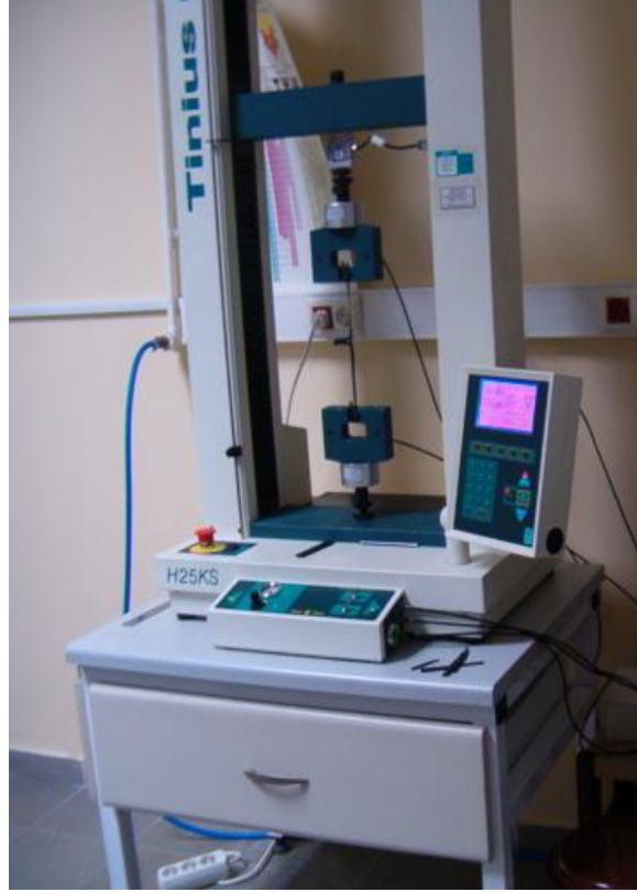
Şekil 4.15. Deneysel çalışmalarda kullanılan yırtılma deney düzeneği.
