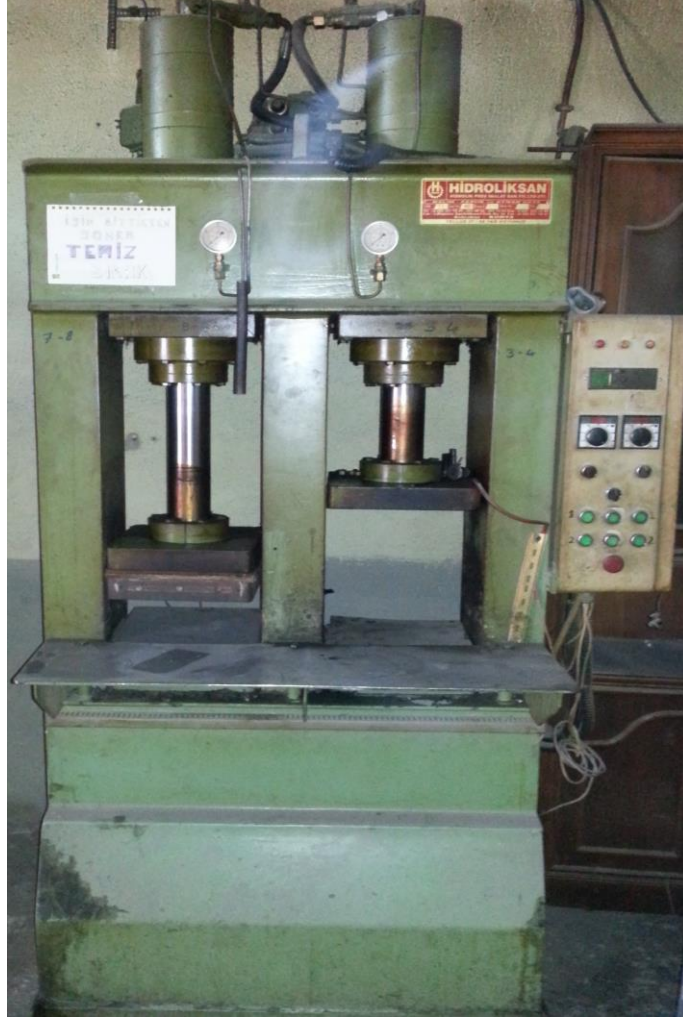
Şekil 4.3. Vulkanizasyon işleminin yapıldığı Hidroliksan marka pres.
