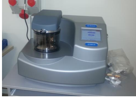
Şekil 4.7. Quorum marka Q 150R ES model kaplama cihazı.
