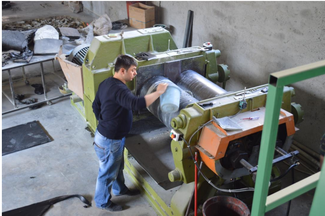
Şekil 4.2. Son karıştırma işleminin yapıldığı açık karıştırıcı.
