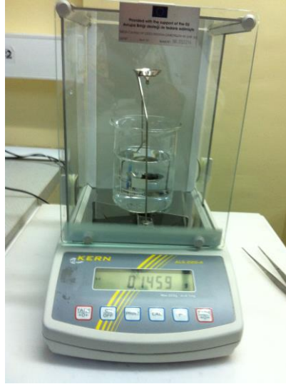
Şekil 4.9. Yoğunluk ölçümünde kullanılan deney düzeneği.
