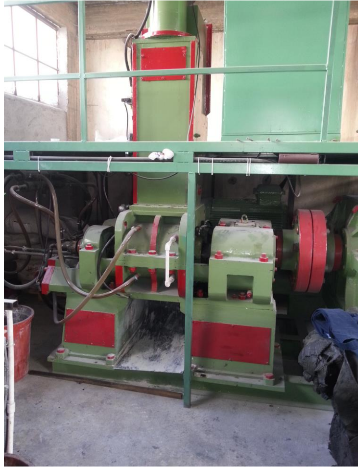
Şekil 4.1. Banbury tipi iç karıştırıcının genel görünümü.
