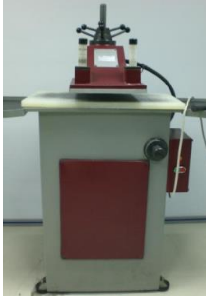
Şekil 4.4. Deney numunelerinin hazırlanmasında kullanılan kesme presleri.
