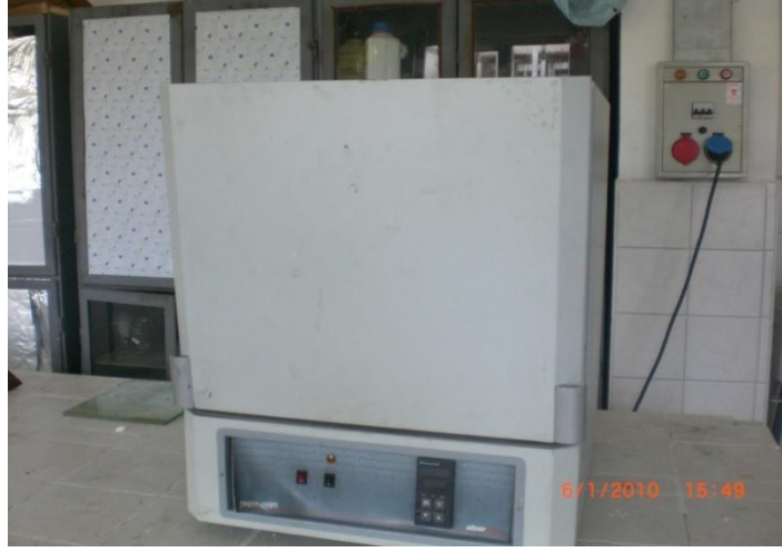
Şekil 4.3. PROTHERM marka ve PLF 120/27 model ısıl işlem fırını.
