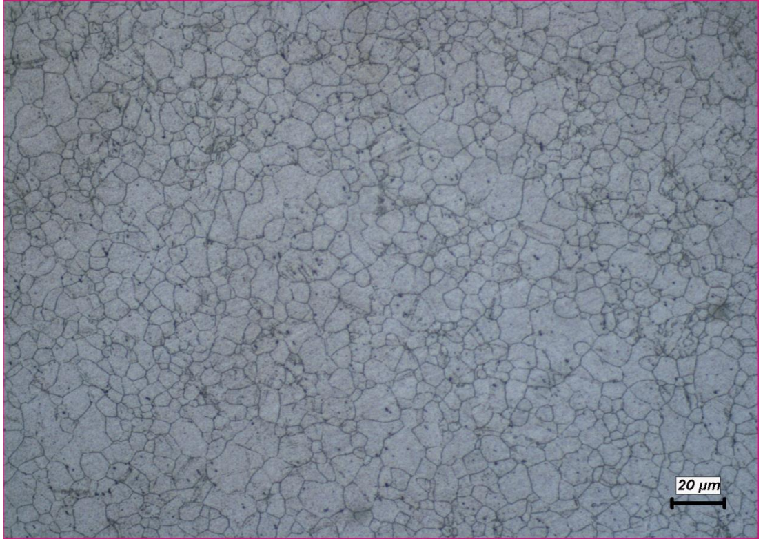
Şekil 5.3. 180 °C’de 30 dakika yaşlandırılan numunenin optik mikroskop görüntüsü.
