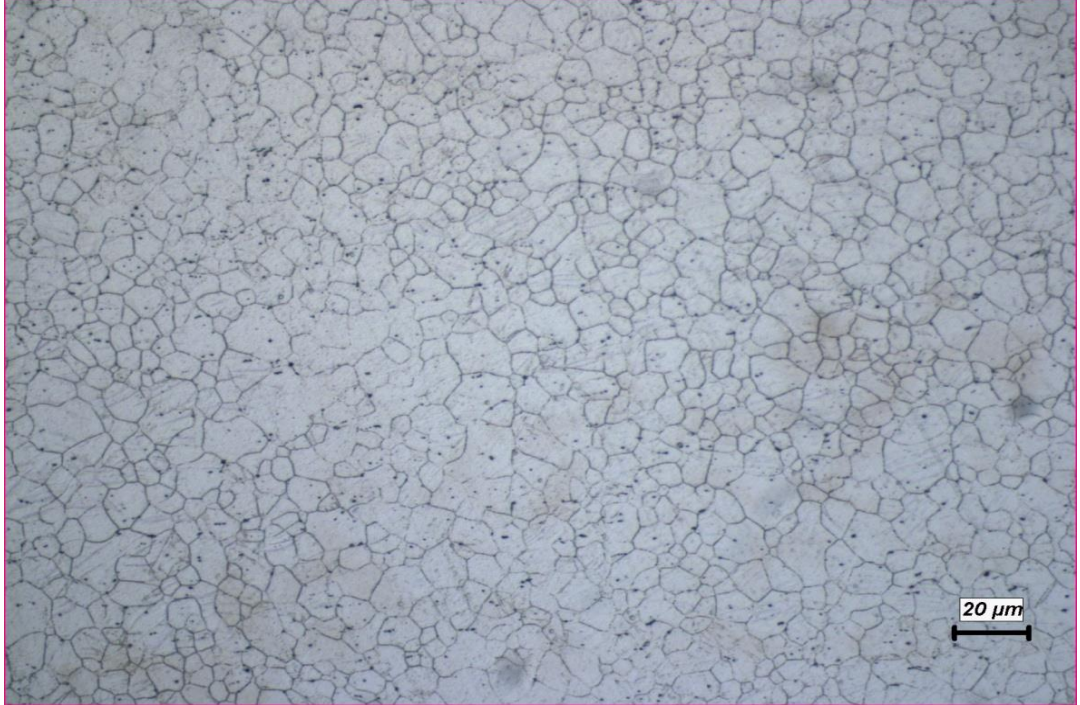
Şekil 5.7. 180 °C’de 5,5 saat yaşlandırılan numunenin optik mikroskop görüntüsü.
