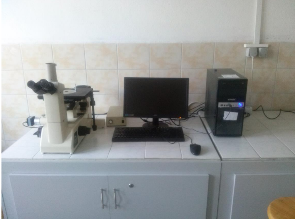
Şekil 4.5. X50-X1000 büyütme kapasitesine sahip Epiphot 200 Nikon marka optik mikroskop.
