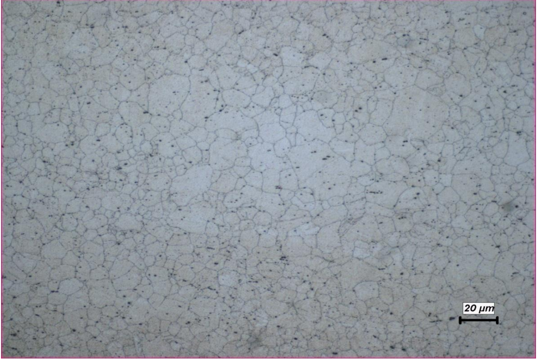
Şekil 5.6. 180 °C’de 4 saat yaşlandırılan numunenin optik mikroskop görüntüsü.
