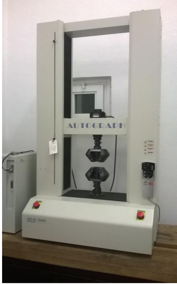
Şekil 4.4. SHIMADZU AG-IS marka 50 kN kapasiteli çekme test cihazı.
