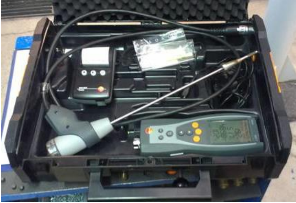
Şekil 5.45. Testin yapıldığı, TESTO - 350 analyzer marka emisyon ölçüm cihazı.
