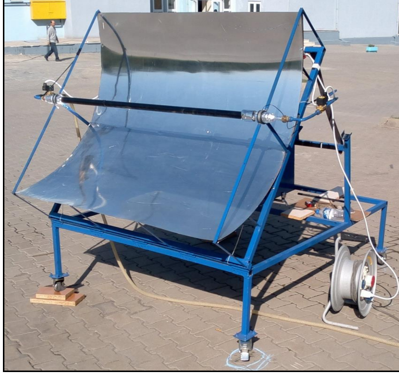
Şekil Ek A.2. Tez dâhilinde tasarlanıp imalatı yapılan sistemin performans anındaki fotoğrafı.
