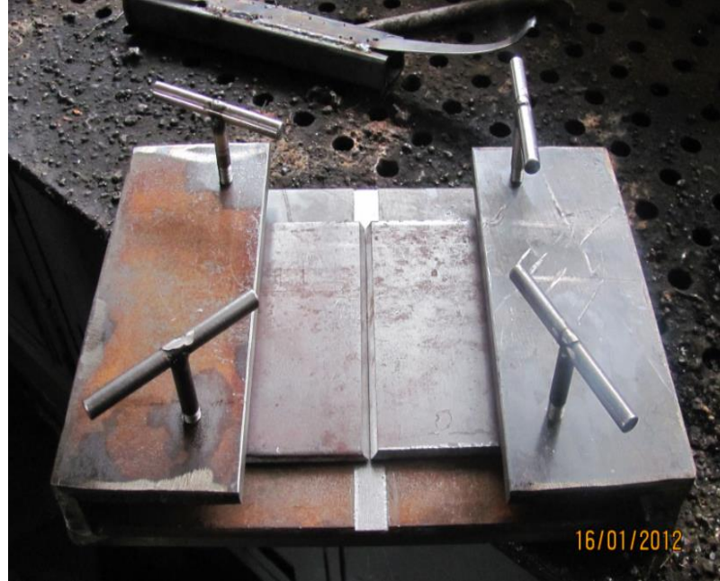
Şekil 5.3. Kaynak yapılmadan önce plakaların yerleştirilmesi.
