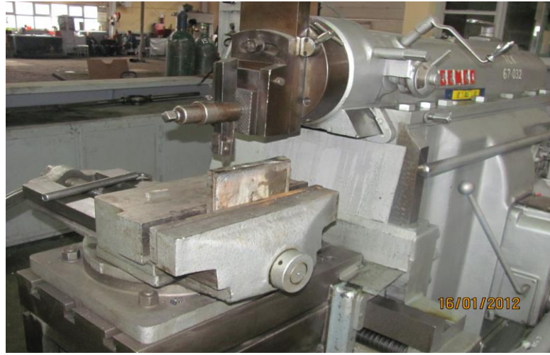
Şekil 5.1. Kaynak ağzı için planyada işlem.
