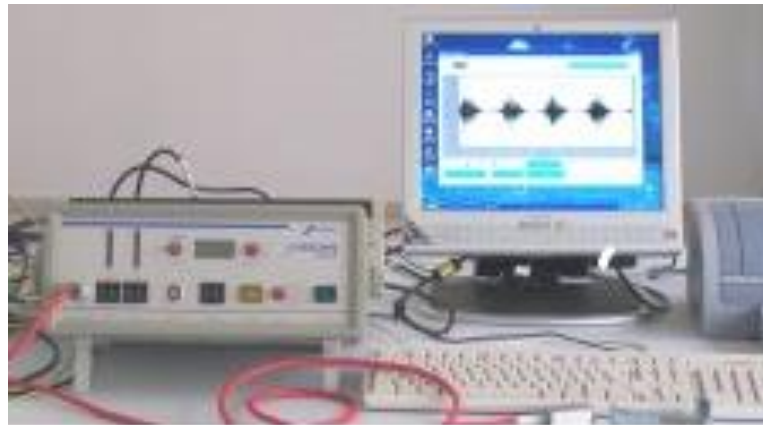
Şekil 2.9. Manyetik Barkhausen yöntemi.
