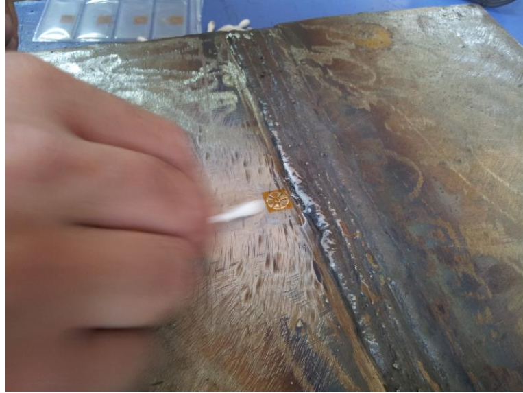
Şekil 5.6. Kaynak edilmiş gemi sacı üzerinin temizlenmesi.
