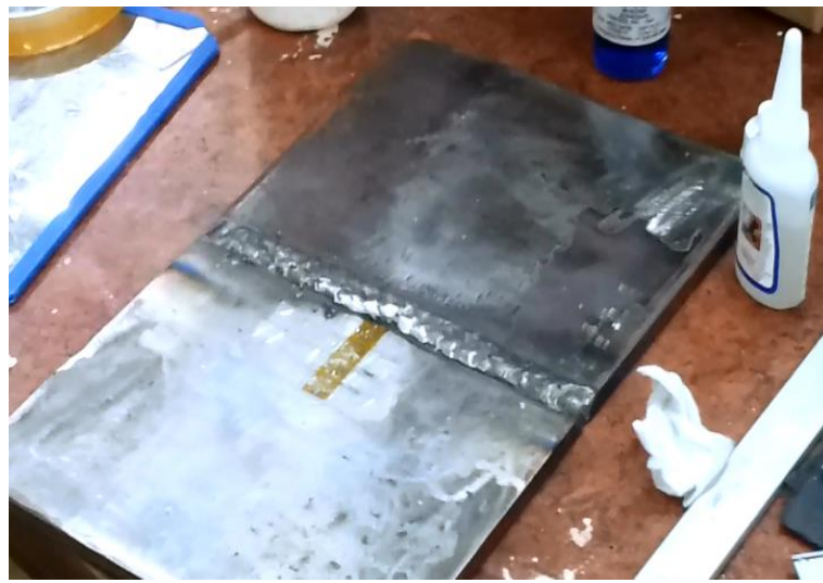
řekil 5.8. Kaynak edilmiř gemi sacı üzerine gerilim ölçer yerleřimi.
