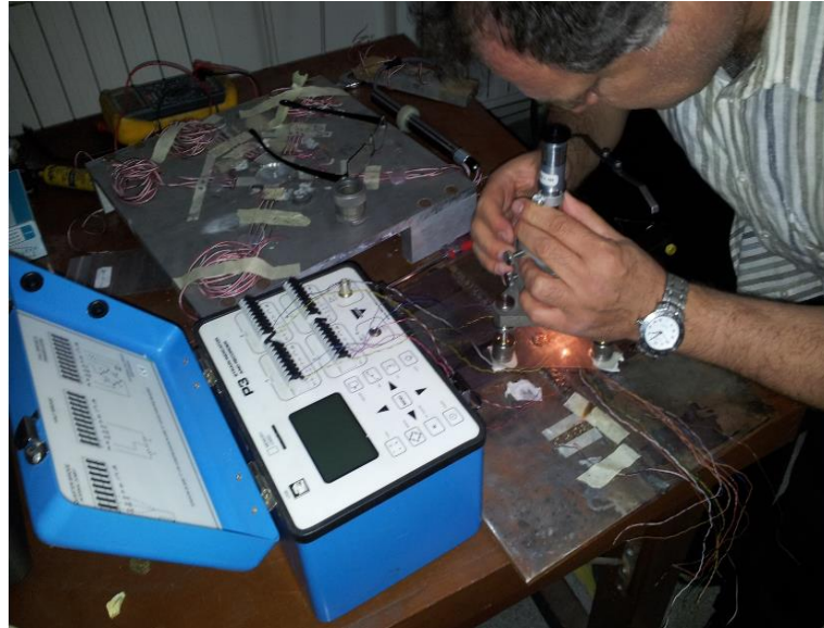
Şekil 5.12. Kabloların girişlere takılması.
