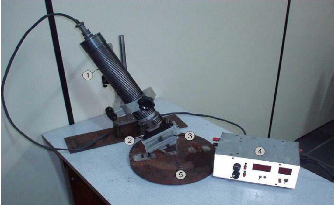
Şekil 2.4. Taşınabilir X ışını kırınımı; 1-yüksek voltaj kaynağı; 2-X-ışını tüpü; 3-ışın düzenleyici ünitesi; 4-kontrol ünitesi; 5-örnek.
