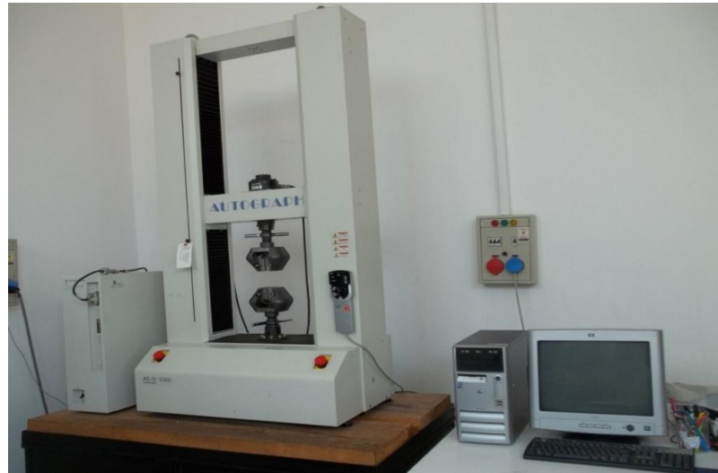
Şekil 3.6. Shimadzu marka çekme deney cihazı.
