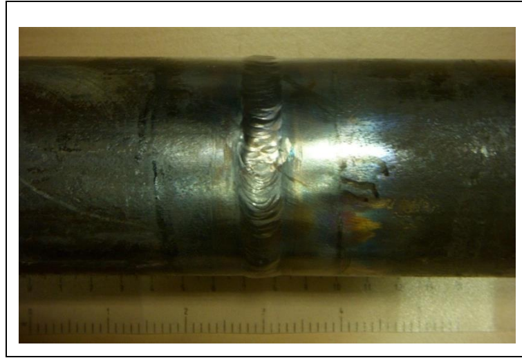
Şekil 3.2. TIG kaynağı ile birleştirilen boru malzemeleri.
