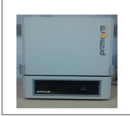
Şekil 3.4. PROTHERM marka ve PLF 120/5 model marka ısıtma fırını.
