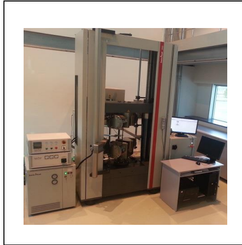
Şekil 3.6. Zwick/Roell marka Z600 model Çekme-Basma-Eğme test cihazı.
