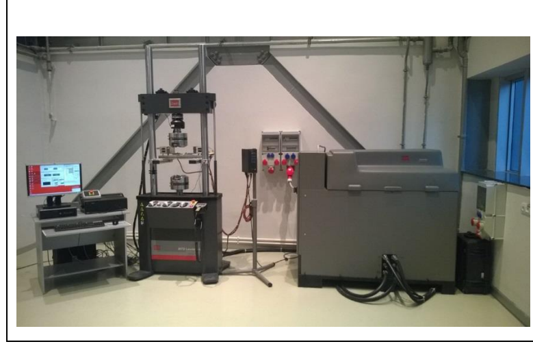
Şekil 3.9. MTS markalı 100kN kapasiteli servohidrolik dinamik test cihazı.
