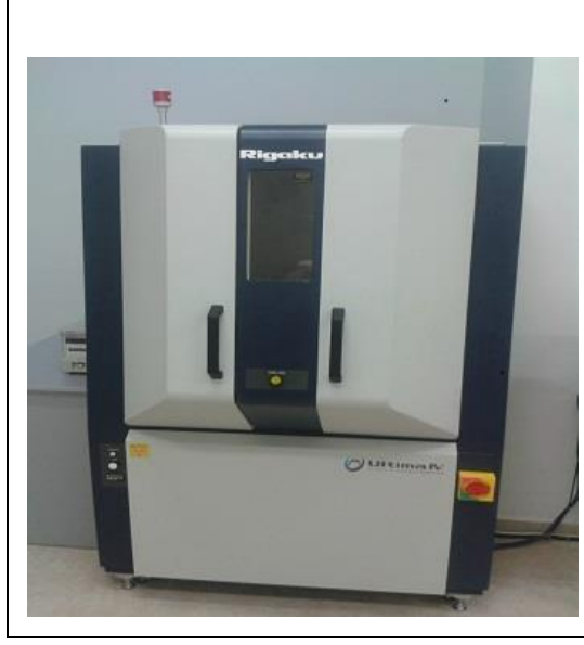
Şekil 3.5. RIGAKU markalı ULTRA IV model XRD cihazı.
