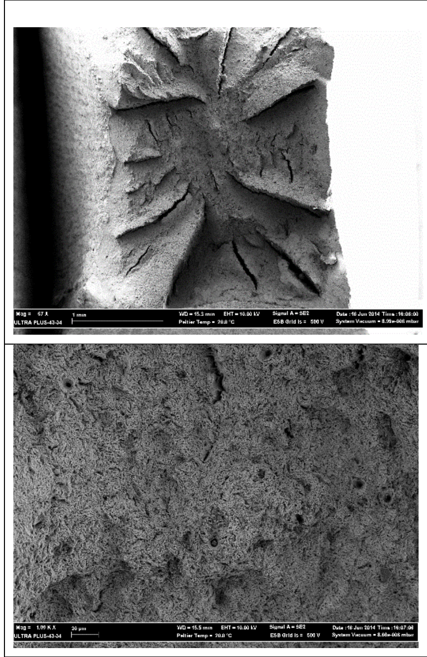
Şekil 4.37. 750°C’de 8 saat PWHT uygulanan P91-P92 kaynaklı birleştirmelerin çekme testi sonrası kırık yüzeyinin SEM görüntüsü.
