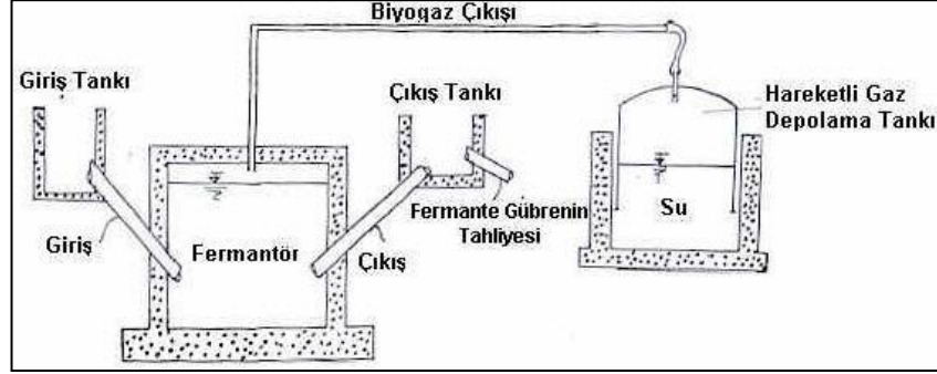
Şekil 2.7. Biyogaz çıkış borusunun hareketli gaz depolama tankına gönderilmesi ve hava ile temasın kesilmesi.
