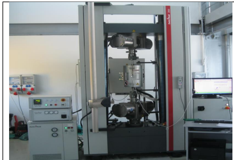
Şekil 3.14. Yüksek sıcaklık çekme testinin yapıldığı Zwick/Roell çekme cihazı.
