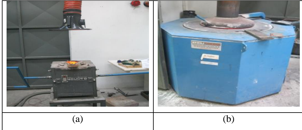
Şekil 3.4. Alaşım ve ergitme işleminin yapıldığı a) indüksiyon ocağı ve b) döküm öncesi kalıbın ön ısıtma yapıldığı fırın.
