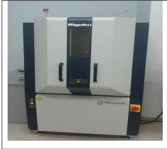
Şekil 3.11. X-ray çekimlerinin yapıldığı Rigaku Ultima IV XRD cihazı.
