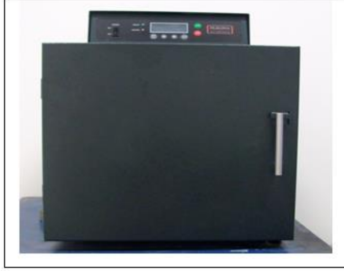
Şekil 3.7. Isıl işlemlerin yapıldığı Magma Therm marka sıcaklık kontrollü elektrikli direnç fırını.
