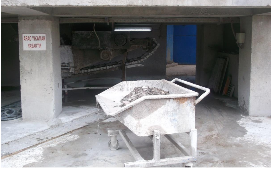
Şekil 3.6. Yanma sonucu ortaya çıkan cürufun kazandan uzaklaştırılması.
