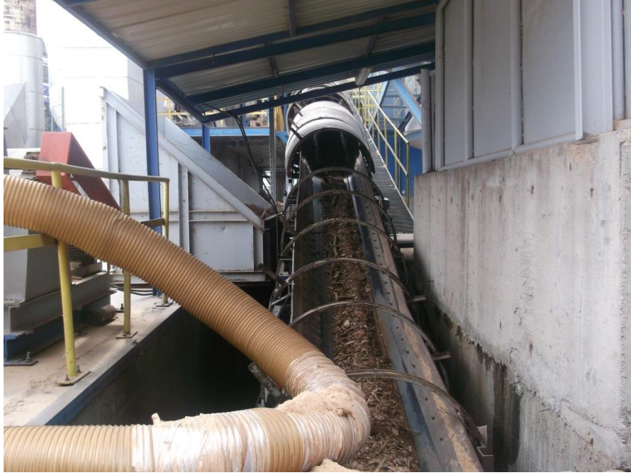
Şekil 3.3. Bantlı konveyör yakıt besleme sistemi.
