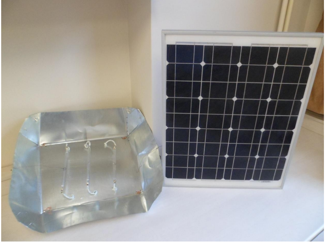
Şekil 5.6. PV panel ve 3000 W halojen lambalı projektör.
