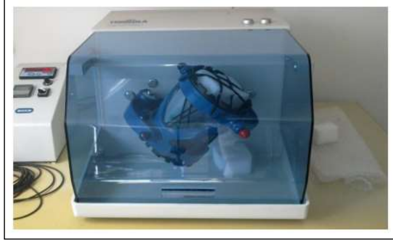
Şekil 6.1. Elementel tozların karıştırılmasında kullanılan Turbula® Shaker Mixer (Model T2F Glenn Mills) tipi karıştırıcı.
