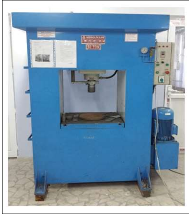
Şekil 6.3. Deney numunelerinin preslendiği "HİDROLİK SAN" marka pres.
