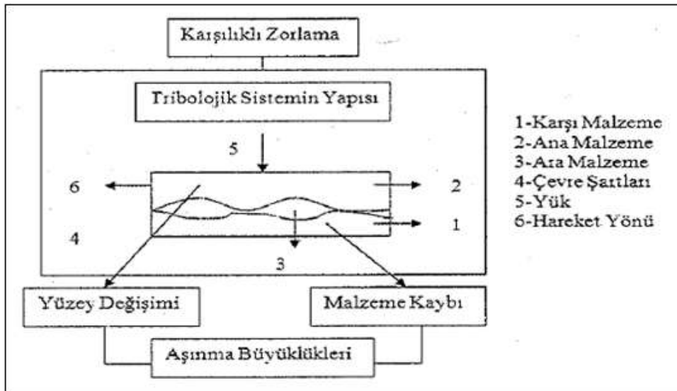
Şekil 5.2. Tribolojik sistemin elemanları [51].
