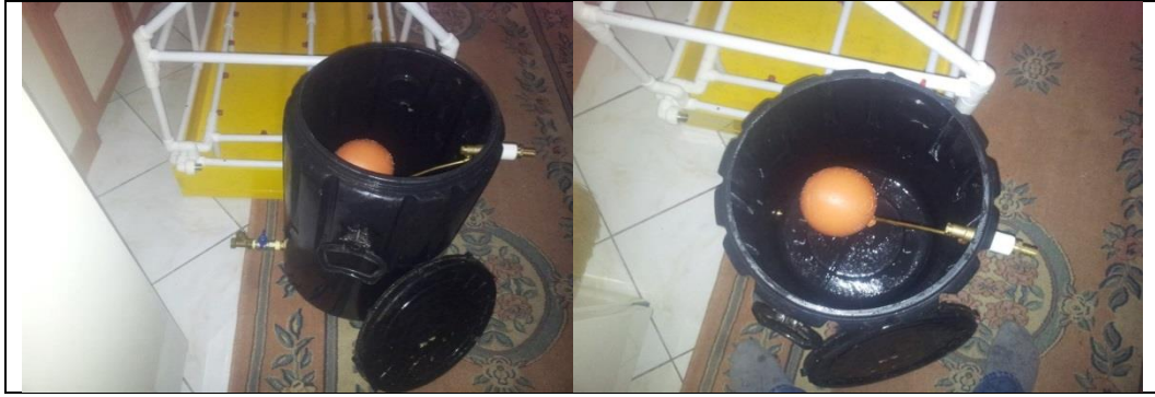
Şekil 3.12. Su miktarının kontrolünde kullanılan flatör.
