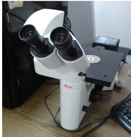
Şekil 5.13. Mikroyapı incelemelerinde kullanılan Leica DM ILM model optik ışık mikroskobu.
