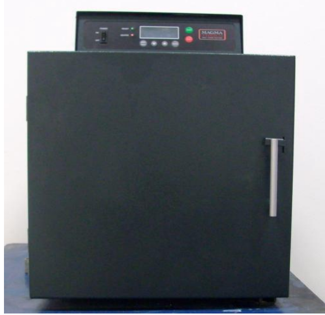
Şekil 5.8. Magma Therm marka sıcaklık kontrollü elektrikli direnç fırını.
