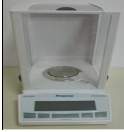
Şekil 5.11. Ağırlık kayıplarının belirlenmesinde kullanılan Precisa marka XS 220A model hassas terazi.
