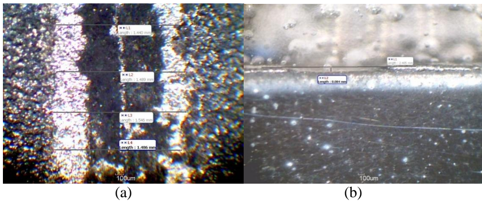
Şekil 6.3. Aşınma deneyi sonrası oluşan aşınma a) iz genişliği ve b) derinliğinin ölçümü.
