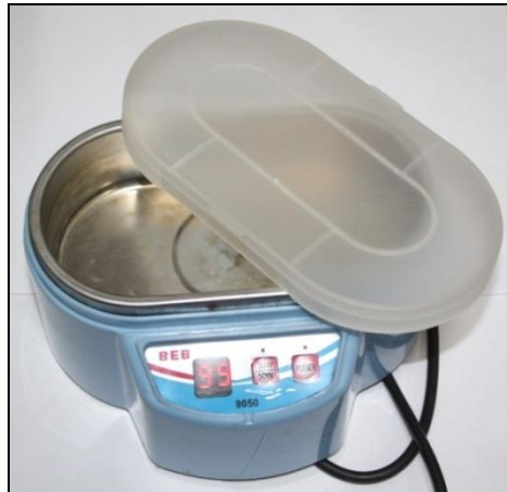
řekil 5.10. Numune temizleme iřlemlerinde kullanılan BEB marka ultrasonik temizleme cihazı.
