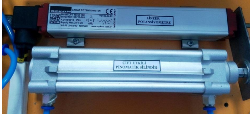
Şekil 3.12. Ø32 mm x 100 mm çift etkili pnömatik silindir.
