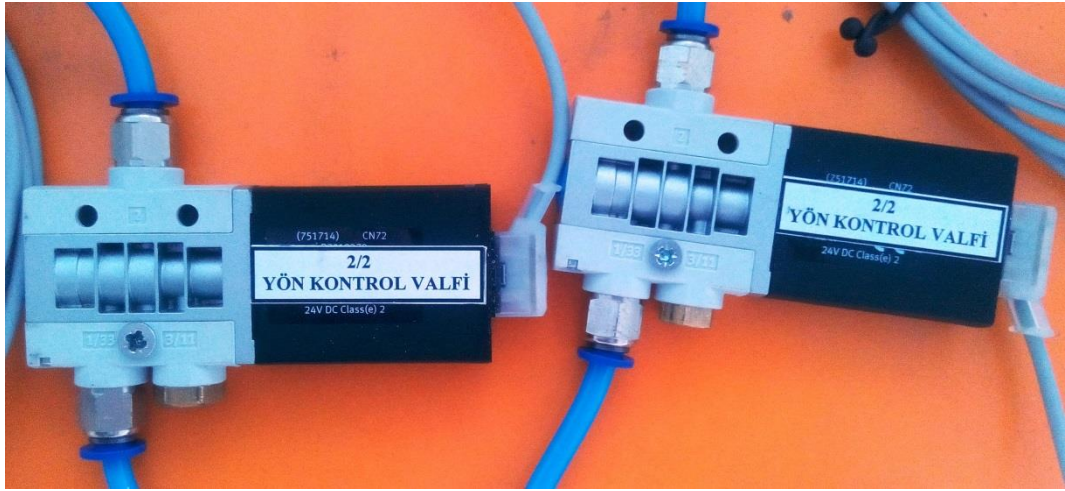
Şekil 3.10. 2/2 selenoid tetiklemeli yay geri getirmeli yön kontrol valfi.
