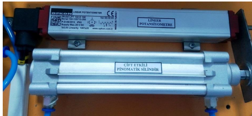
Şekil 3.7. 150mm lineer potansiyometre.
