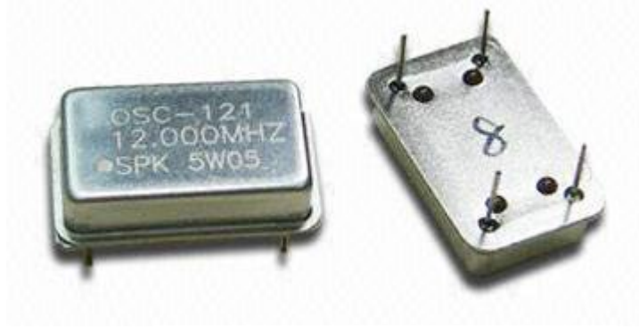
Şekil 3.1. Yüksek frekansta çalışan kristal osilatör.
