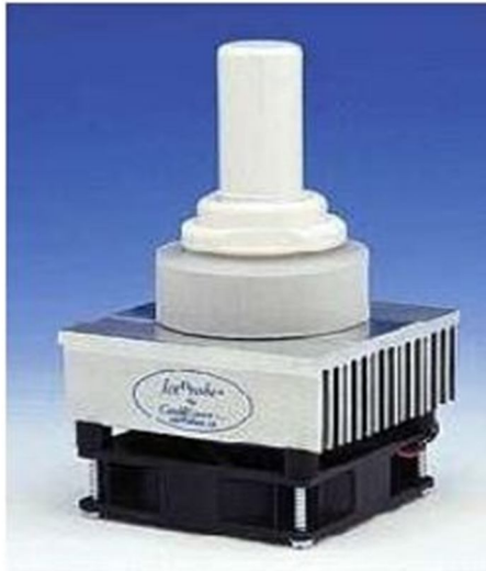
Şekil 3.21. 50 W gücünde bir Buz Sondası [28].
