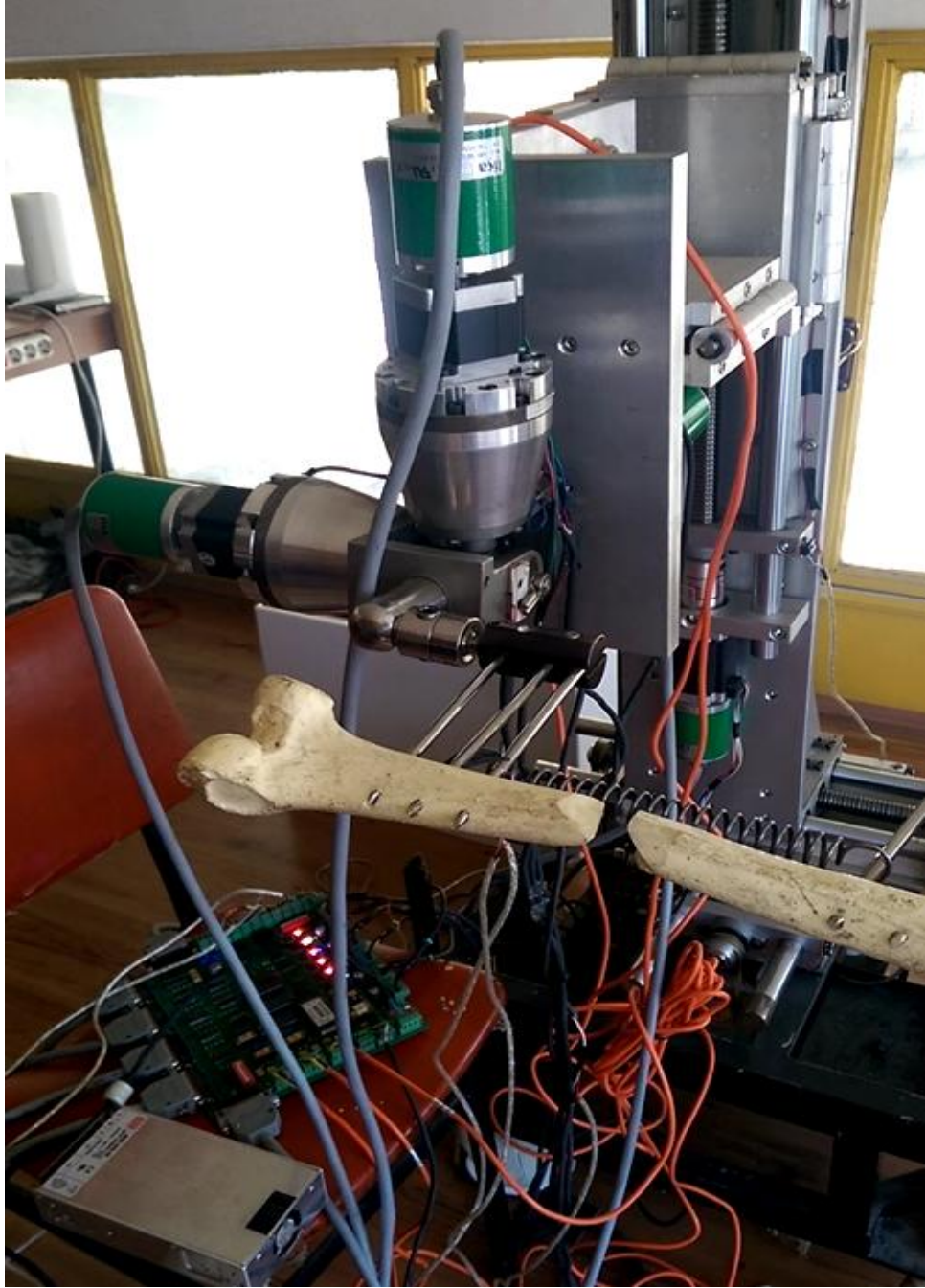
Şekil 7.11. Robotun kırık kemikleri hizalama işlemi yaparken çekilmiş fotoğrafı.
