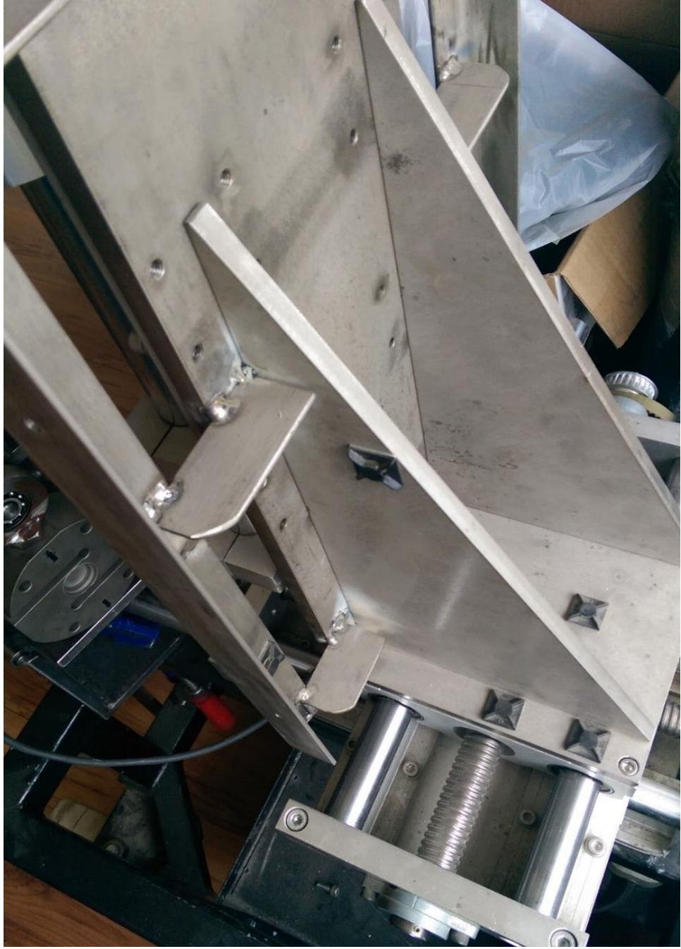
Şekil6.5.Linear modül montaj fotoğrafı (yatay ve dikey hareket).
