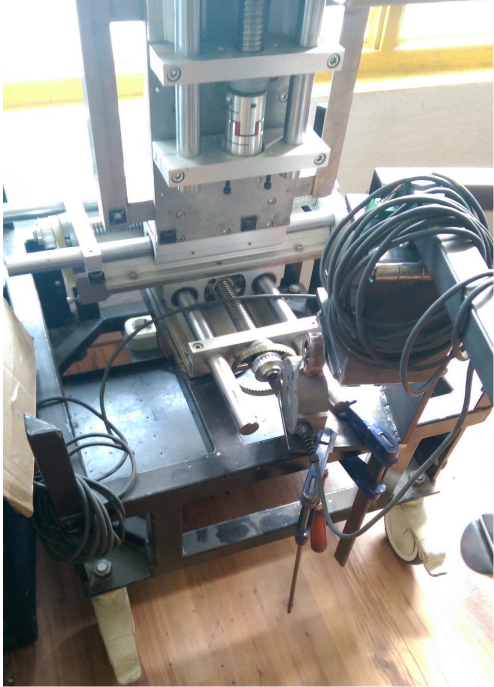
Şekil 6.9. Lineer modül montaj fotoğrafı-1 (yatay ve dikey hareket).
