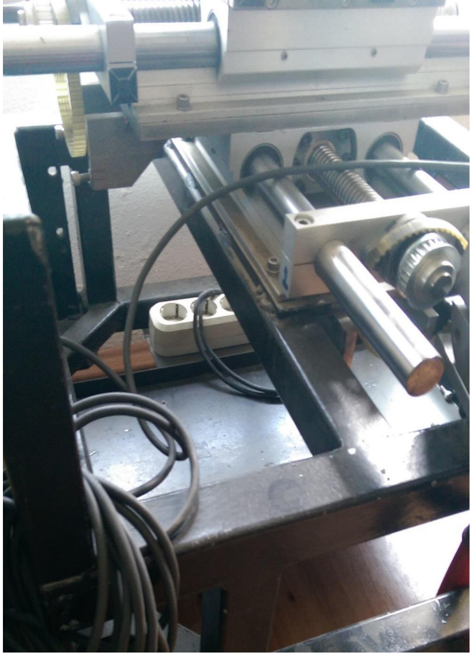
Şekil 6.8. Lineer modül montaj fotoğrafı-2 (yatay hareket).
