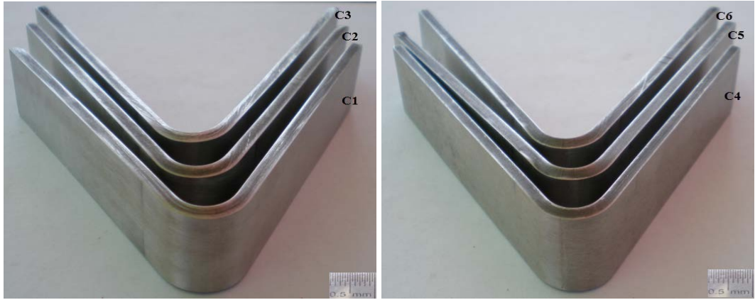
Şekil 4.68. C1; 3500W/90cm/dk, C2; 3500W/180cm/dk, C3; 3500W/270cm/dk, C4; 4000W/90cm/dk, C5; 4000W/180cm/dk, C6; 4000W/270cm/dk parametreleriyle birleştirilen AISI 2205 dubleks paslanmaz çelik numunelerin üç nokta eğme deney sonrası görüntüleri.
