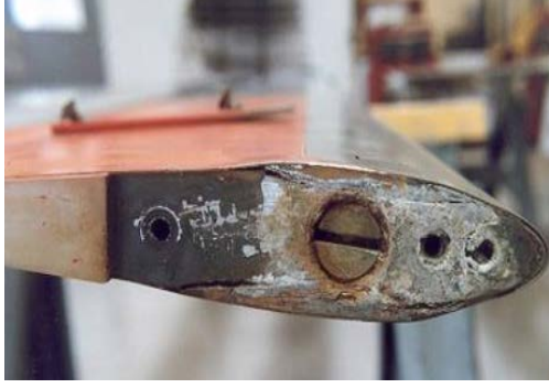
Şekil 2.9. Galvanik korozyon oluşmuş bir numune görüntüsü [73].
