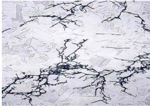
Şekil 2.10. Gerilmeli korozyon oluşumu [69].
