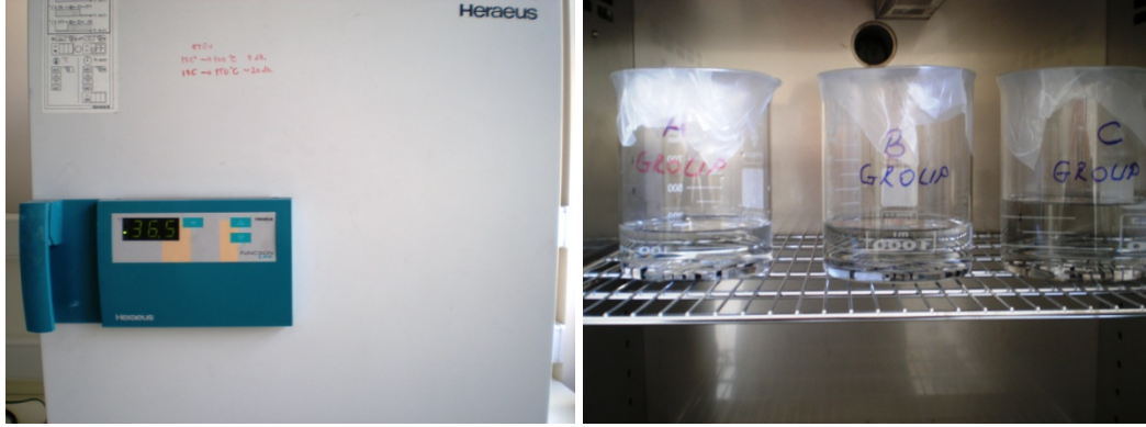
Şekil 3.19. Etüvde (36,5 °C) deney numunelerinin SBF içerisinde tutulması.
