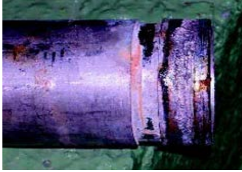
Şekil 2.8. Aralık korozyonu oluşumu [69].
