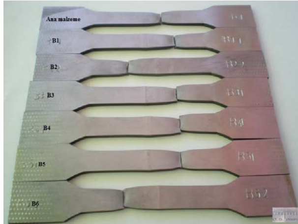
Şekil 4.52. B; Ana malzeme, B1; 3500W/90cm/dk, B2; 3500W-180cm/dk, B3; 3500W/270cm/dk, B4; 4000W/90cm/dk, B5; 4000W/180cm/dk, B6; 4000W/270cm/dk parametreleriyle birleştirilen AISI 420 numunelerine ait çekme deneyi sonrası görüntüleri.
