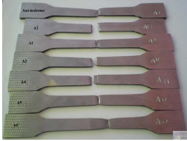
Şekil 4.49. A; Ana malzeme, A1; 3500W/90cm/dk, A2; 3500W/180cm/dk, A3; 3500W/270cm/dk, A4; 4000W/90cm/dk, A5; 4000W/180cm/dk, A6; 4000W/270cm/dk parametreleriyle birleştirilen AISI 316L numunelerine ait çekme deneyi sonrası görüntüleri.
