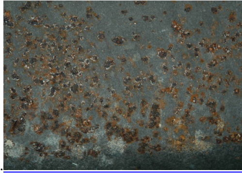
Şekil 2.7. Çukurcuk korozyonu oluşumu [71].
