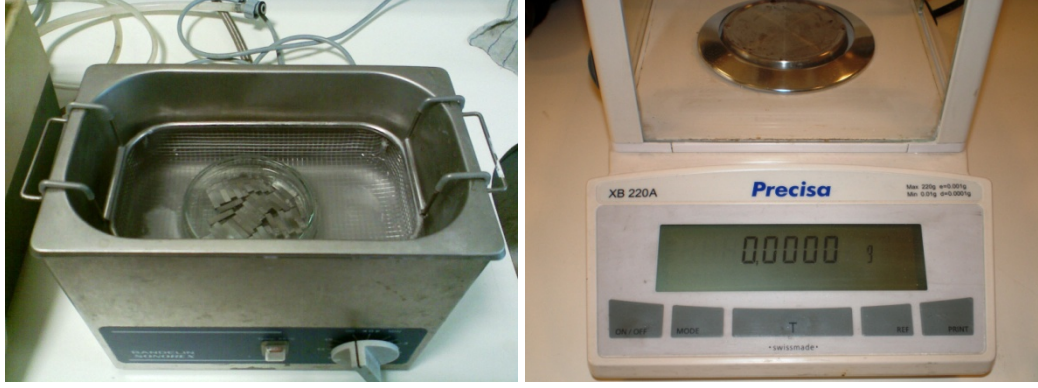
Şekil 3.18. Deney numunelerinin ultrasonik banyoda temizlenmesi ve hassas terazide ağırlık ölçülmesi işlemi.
