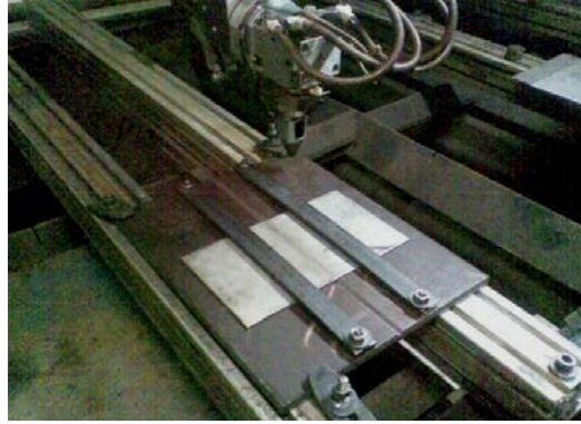
Şekil 3.3. Numunelerin tutucu kaynak aparatına ve lazer ünitesine bağlanması.
