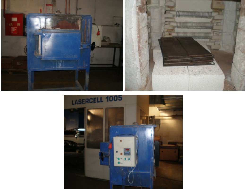
Şekil 3.7. Kaynak öncesi ön tav ve kaynak sonrası son tav ısıl işleminin uygulanışı.
