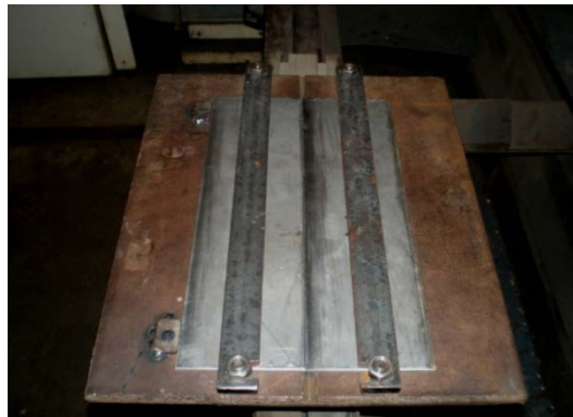
Şekil 3.1. Lazer kaynaklı birleştirme için geliştirilen tutucu kaynak aparatı.
