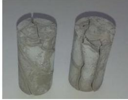
Şekil 2.5. Na-Metakaolin esaslı jeopolimerin (Si/Al=1,90) oda sıcaklığına 40 gün maruz kaldıktan sonraki görüntüsü [29].
