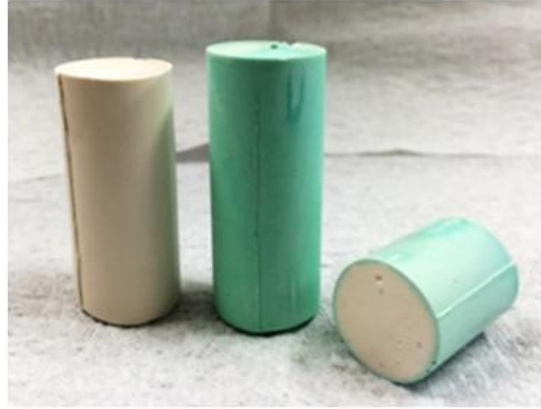
Şekil 2.7. Bakır iyonları ile renklendirilmiş jeopolimerler [40].
