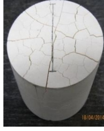
Şekil 6.6. Isıl işlem sonrasında çatlaklar içeren monolitik jeopolimer.
