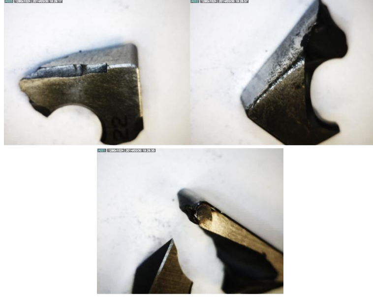
Şekil 4.9. Seramik takımla yapılan ön deneylerde düşük ve yüksek kesme hızlarında takımda meydana gelen kırılma aşınması görüntüsü.
