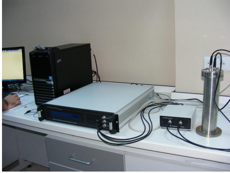
Şekil 4.16. Kesici takımların elektrik iletkenliklerinin ölçüldüğü yüksek performanslı frekans analizci.
