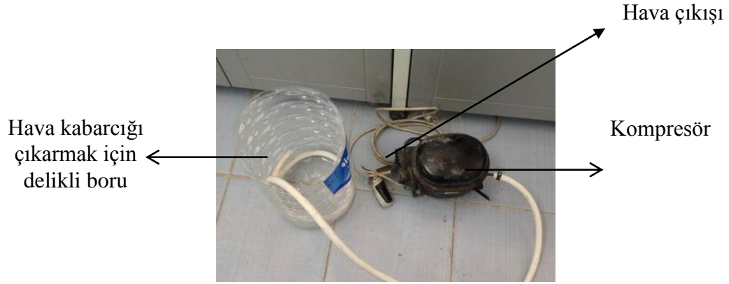
Şekil 5.17. Biyodizel hava kabarcıklı yıkama düzeneği.
