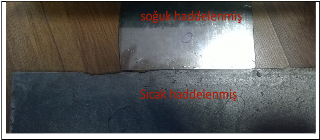
Şekil 3.3. Sıcak ve soğuk haddelenmiş sac.
