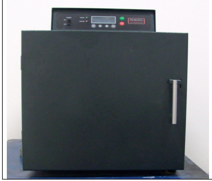
Şekil 3.4. Isıl işlemlerin yapıldığı Magma Therm marka ısıl işlem fırını.
