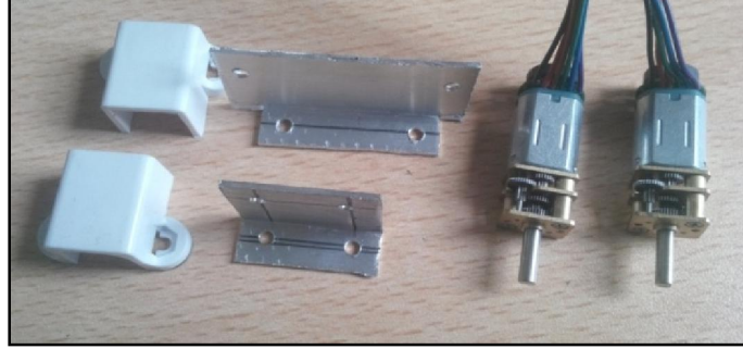
Şekil 3.8. Motor, motor tutucu ve sensör tutucular.
