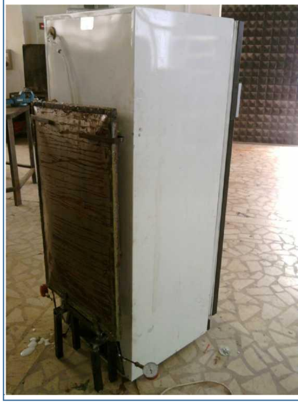
Şekil 4.3. Yağ soğutmalı kondenser ve soğutucuya montajlanmış görünümü.
