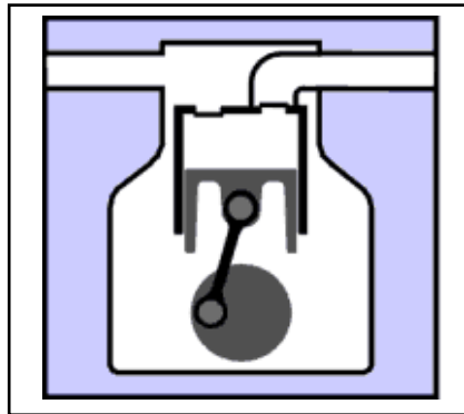
Şekil 3.5. Açık tip pistonlu kompresör.
