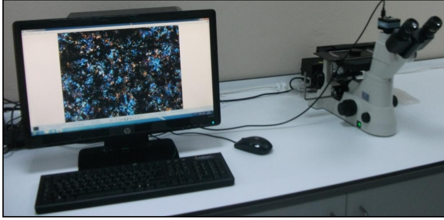
Şekil 4.17. Bakalite alınmış ve yüzeyi parlatılmış numunelerin mikroskobik yüzey analizlerinin incelenmesinde kullanılan ECLIPSE MA100 optik mikroskop görüntüsü.
