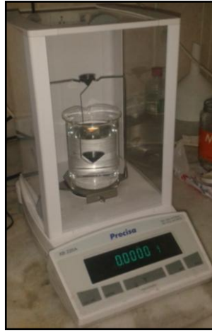
Şekil 4.9. Üretimi gerçekleştirilen karma takviyeli MMK malzemelerin yoğunluklarının belirlenmesinde kullanılan hassas terazi ve yoğunluk ölçüm kiti görüntüsü.
