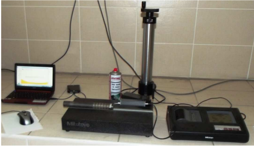
Şekil 4.18. Mitutoyo (SJ-300) masaüstü sütunlu yüzey pürüzlülük ölçüm cihazı görüntüsü [112].
