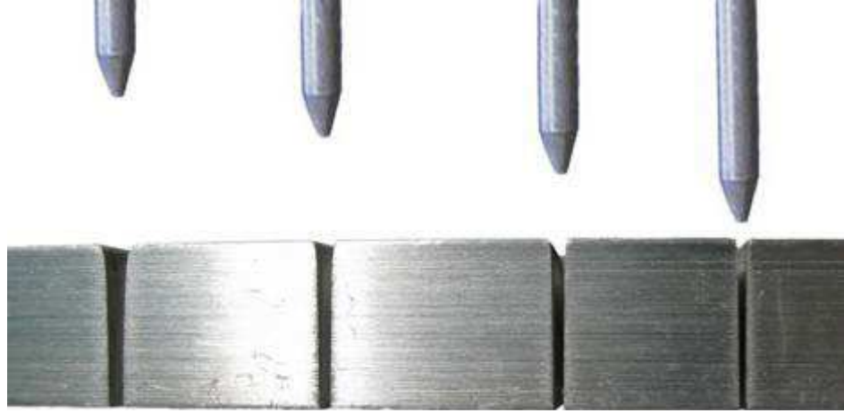
Şekil 5.30. ASJ işleminde nozul yaklaşma mesafesinin kerf oluşumuna etkisi [116].
