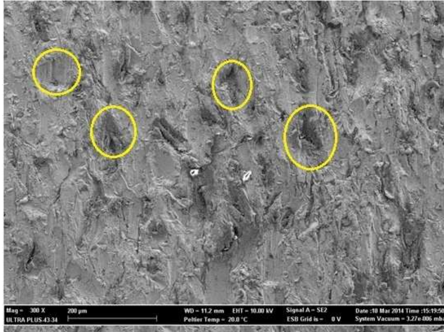
Şekil 5.37. AISI 1050 çeliği iş parçasının ASJT işleminde nozul çapı (1,3 mm) değerlerinin mikro yüzey pürüzlülüğüne etkisini gösteren 300x büyütmeli SEM görüntüsü (NYM 2 mm, NİM 5 mm/dak, AAO 50 g/dak ve TD 500 dev/dak).
