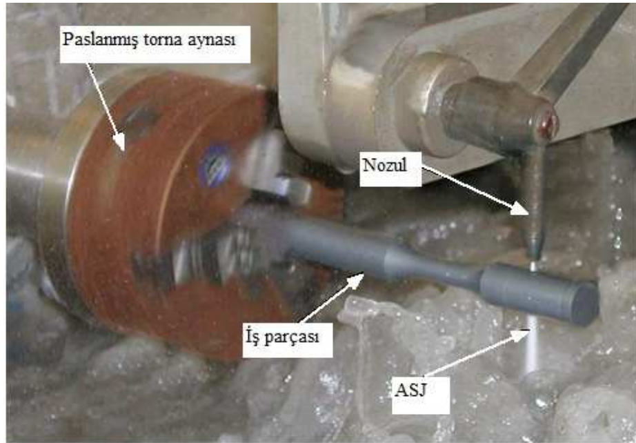
Şekil 3.7. ASJT deney düzeneği ve ASJ ile işleme anı görüntüsü [84].
