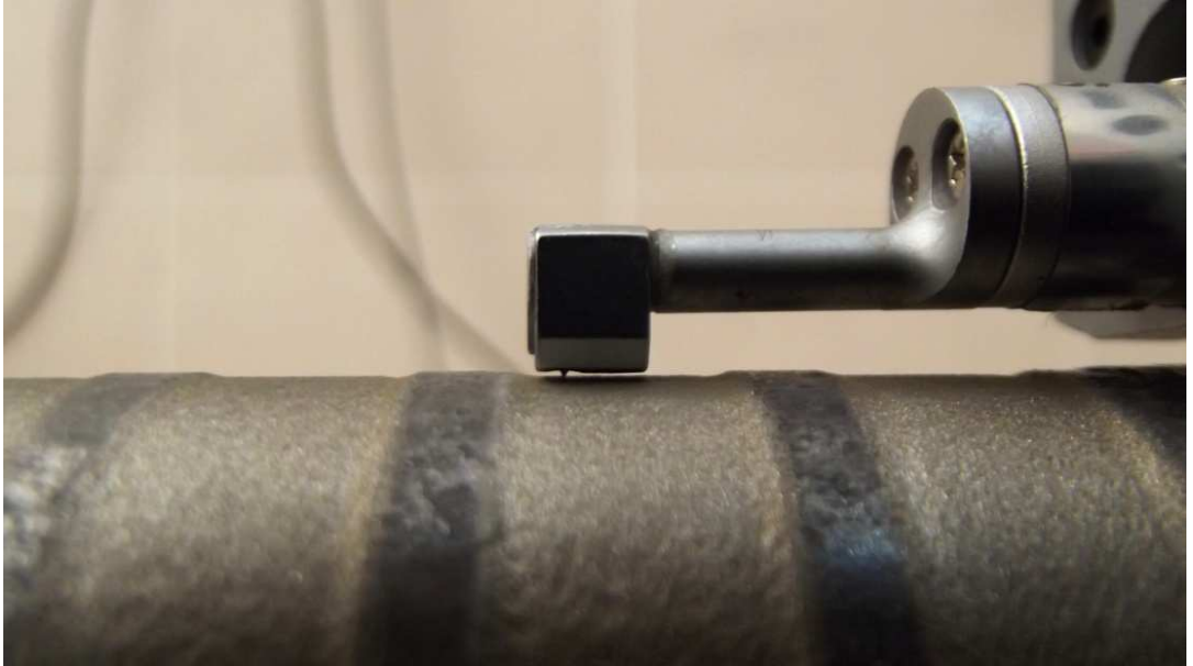
Şekil 4.19. ASJT ile işlenen AISI 1050 çeliğinin yüzey pürüzlülük ölçümü gösterimi.
