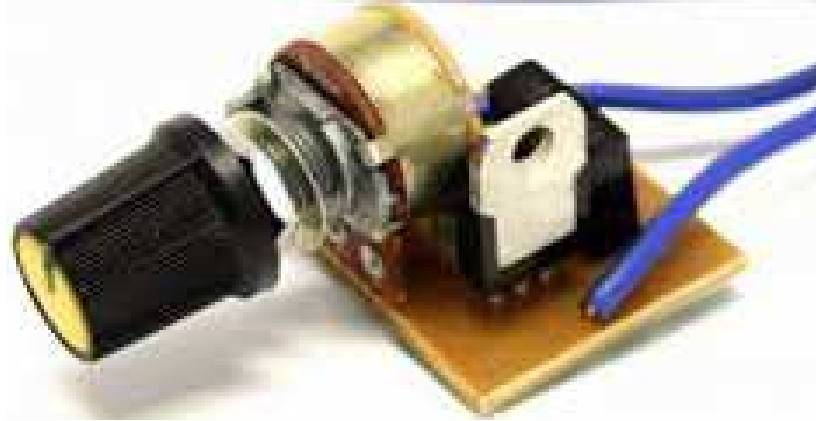
Şekil 4.2. Motor devri için kullanılan ayarlanabilir elektronik kontrol devresi görünümü.
