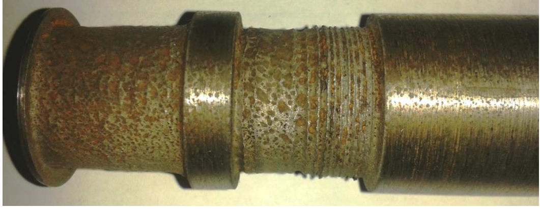
Şekil 4.13. AISI 1050 malzemenin ASJT ile işlenmesinde, iş parçasının dönüş yönünün ASJ ile zıt yönlü olmasının durumunda iş parçası yüzeyinde meydana gelen yüzey bozuklukları görüntüsü.
