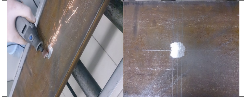
Şekil 4.2. Ray numunesinin otomatik zımpara taşı ile temizlenmesi.
