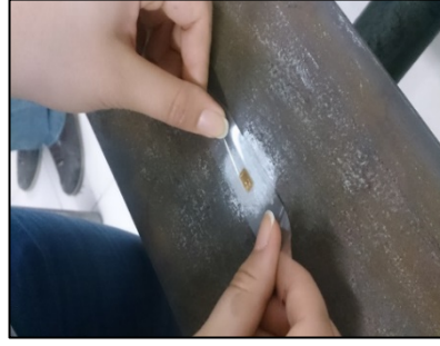
Şekil 4.6. Strain gage'in raya yapıştırılması.
