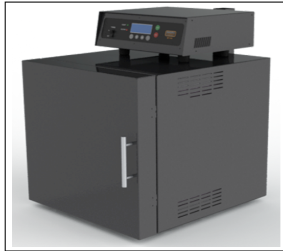
Şekil 3.5. Çözeltiye alma ve yaşlandırma ısıl işlemlerinin yapıldığı Magmatherm (MT1220) fırınının görüntüsü.
