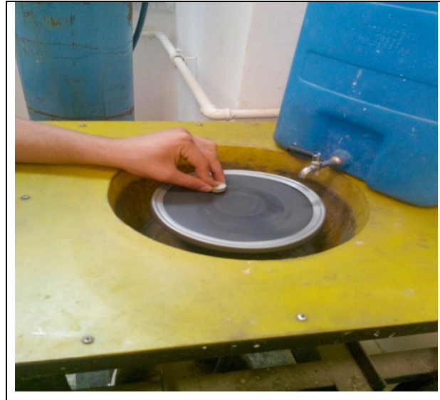
Şekil 3.6. Zımpara ve parlatma işlemlerinin yapıldığı düzenek.
