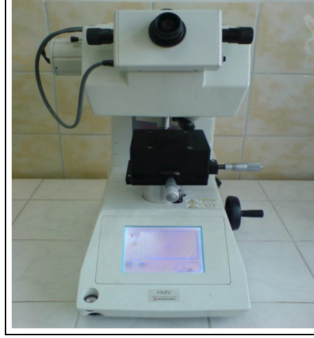
Şekil 3.10. Sertlik ölçümlerinde kullanılan mikro sertlik test cihazı.
