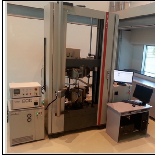
Şekil 3.11. Deneysel çalışmalarda kullanılan çekme test cihazının görüntüsü.
