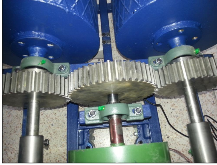
Şekil 4.17. Sistem üzerinde montajı yapılan dişliler.
