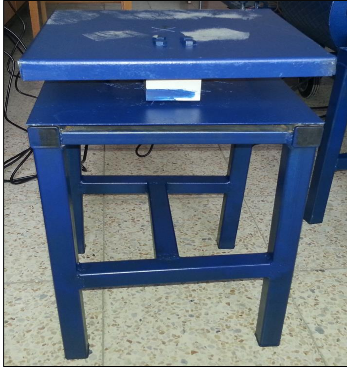
Şekil 4.4. Arka tekerlerden ağırlık ölçümü için tasarlanan ve üretilen platform.
