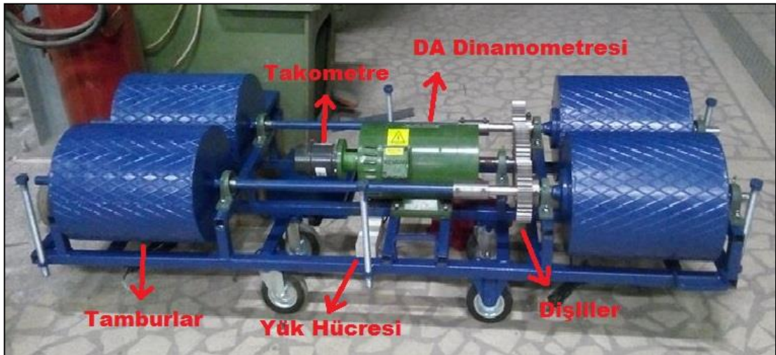
Şekil 4.3. Tasarıma bağlı üretilen şasi dinamometresi.
