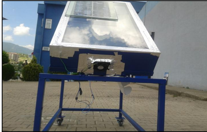
Şekil EK A.4. Kollektör girişine yerleştirilen fan.
