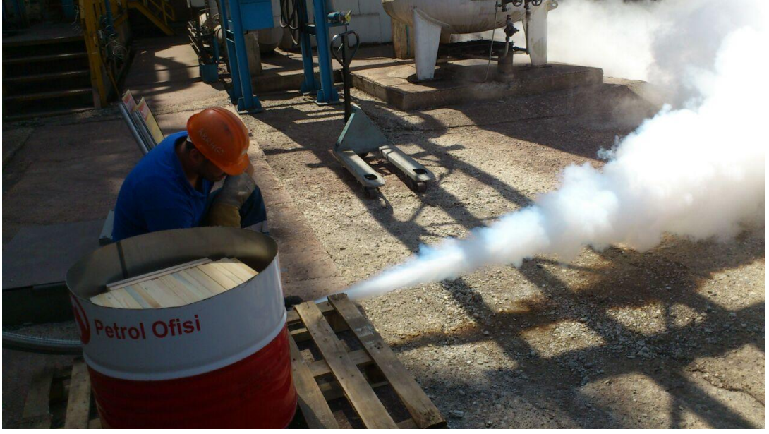
Şekil 3.3. Kardemir A.Ş. enerji tesislerinde deney numunelerinin sıvı azot'a tatbiki.
