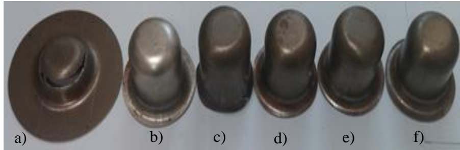
Şekil 6.13. SSS değerinin 0 °C olduğu koşulda derin çekilmiş AA7075-T6 alaşımı malzemeler a) ŞSE-6, b) ŞSE-5, c) ŞSE-4, d) ŞSE-3, e) ŞSE-2, f) ŞSE-1.
