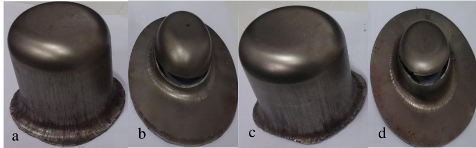
Şekil 6.4. Maksimum baskı levhası basıncının belirlenmesi deneylerinde elde edilen numunelerin görüntüsü; a) ŞSE-4, 5,48 MPa, b) ŞSE-4, 11,76 MPa, c) ŞSE-1, 11,76 MPa, d) ŞSE-1, 15,68 MPa.
