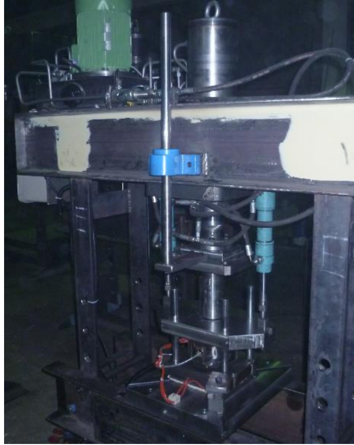
Şekil 5.4. Kılavuz miller ile kalıpların merkezlenmesi.
