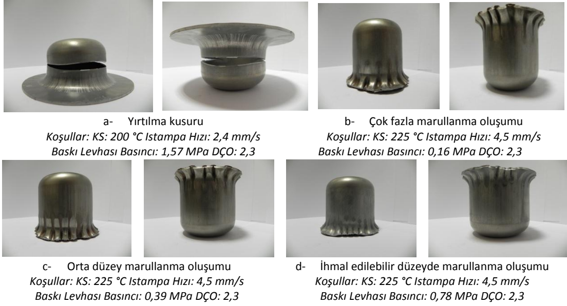
Şekil 6.2. Marullanma kusuru görülen derin çekilmiş kaplar.
