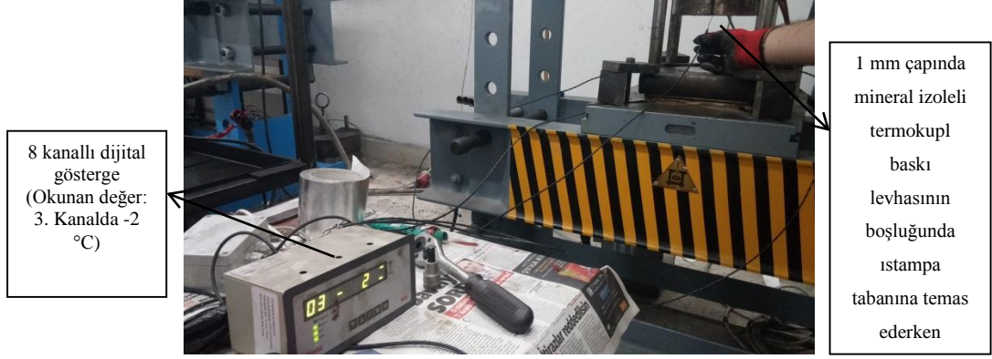
Şekil 4.7. Soğutulan ıstampa tabanında ölçülen sıcaklık değeri.
