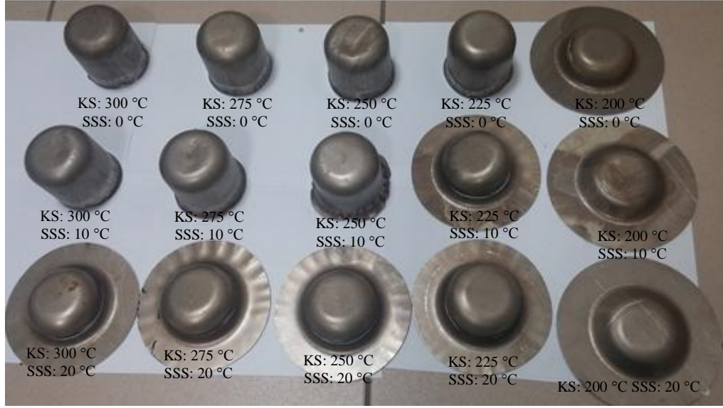
Şekil 6.12. Farklı ŞSE koşullarında derin çekilmiş AA6061-T6 alaşımı malzemeler.
