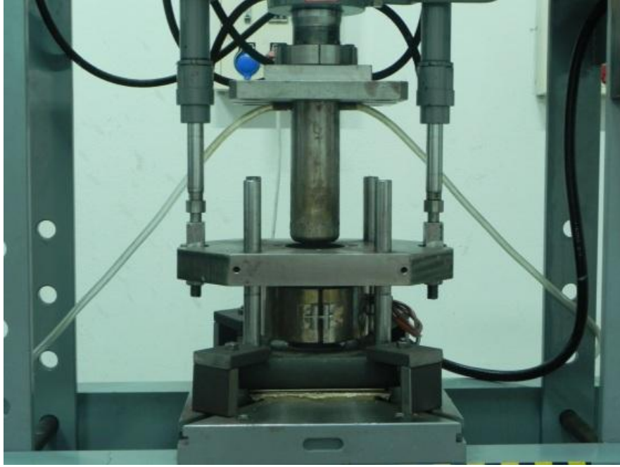
Şekil 5.5. Ilık derin çekme işleminde kullanılan sistemin gerçek görüntüsü.
