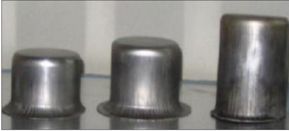
Şekil 2.14. 2, 2.5 ve 3 derin çekme oranlarında çekilmiş numune görüntüleri [33].
