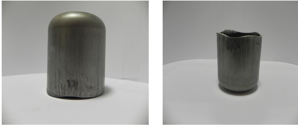
Kulaklaşma hatası oluşan tam derin çekilmiş bir kap Koşullar: KS: 200 °C Istampma Hızı: 4,5 mm/s Baskı Levhası Basıncı: 1,57 MPa DÇO: 2,3 Maksimum ve minimum kap yükseklikleri fotoğrafta görülmektedir
