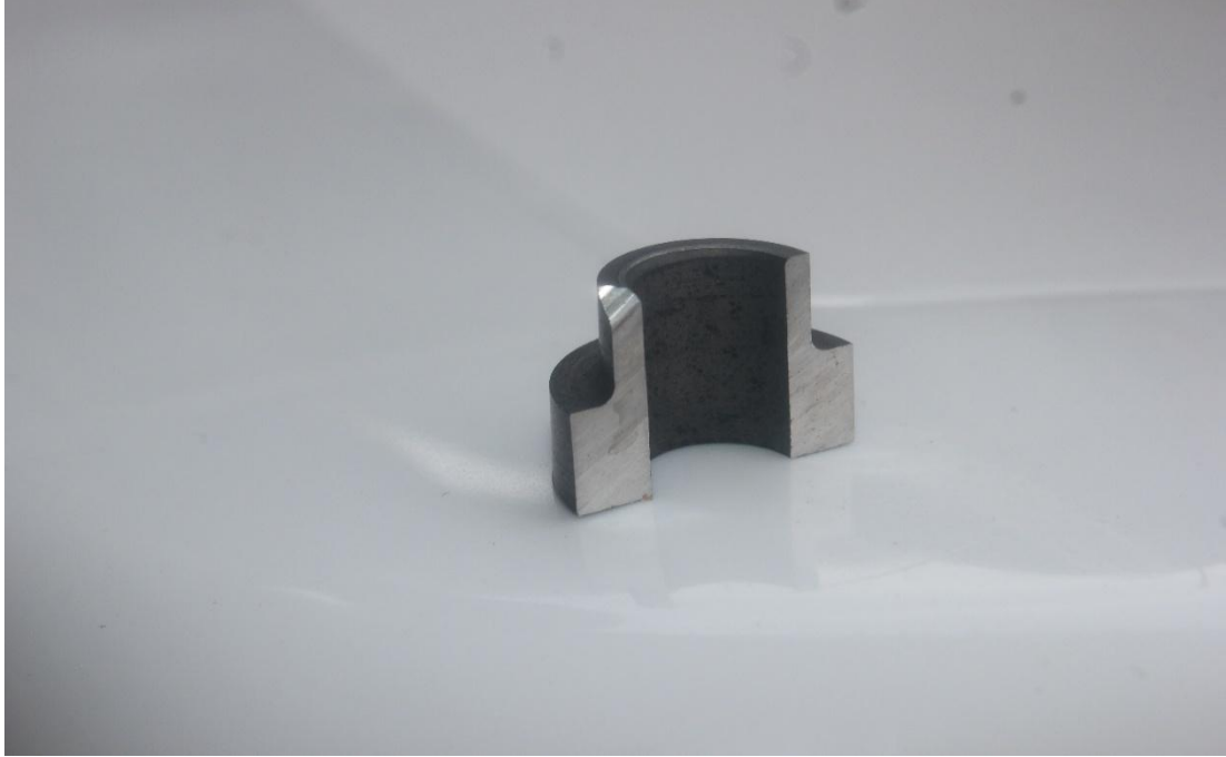
Şekil 5.9. Kesme sıvısı kullanılarak 2000 dev/dk'da 10 mm/dk ilerleme hızında kesilen parça.
