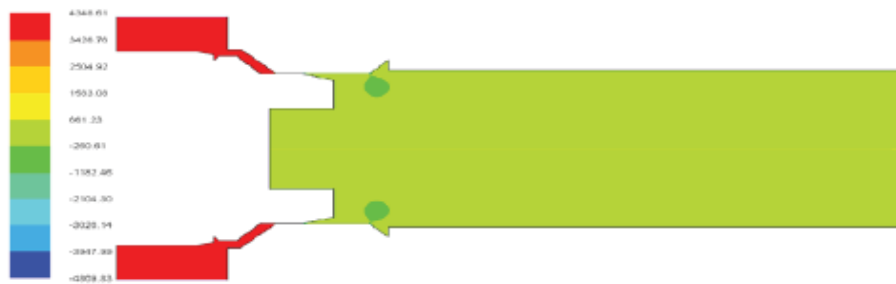
Şekil 3.1. Örnek bir modelde orifis sonrası buharlaşma basıncı altına düşen bölgeyi gösteren basınç konturu [18].
