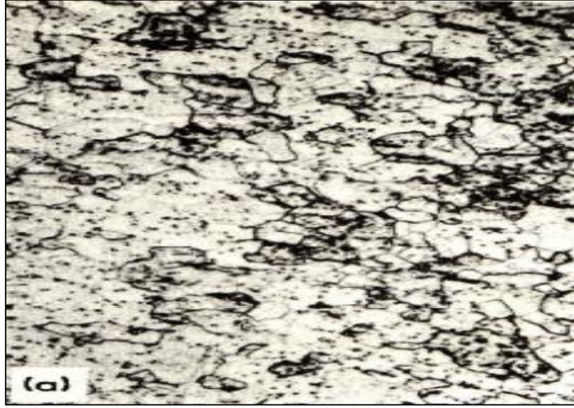
Şekil 4.5. %12 Krom içeren ferritik paslanmaz çelik (500x) [29].
