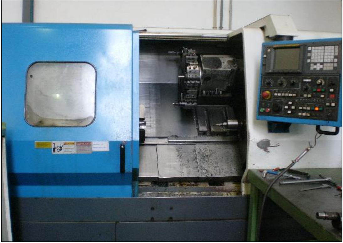
Şekil 6.5. Johnford TC-35 sanayi tipi CNC torna tezgâhı.
