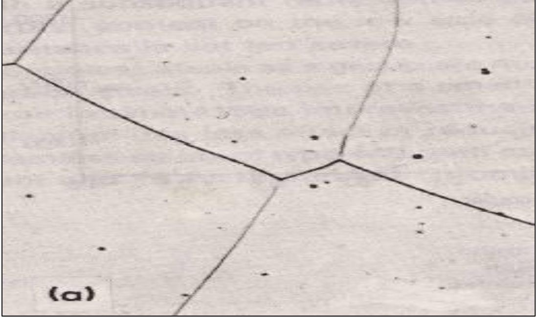
Şekil 4.4. %18 Krom ve %0,03 karbon içeren ferritik paslanmaz çelik 1150°C'den hızlı soğutulmuştur (500x) [29].
