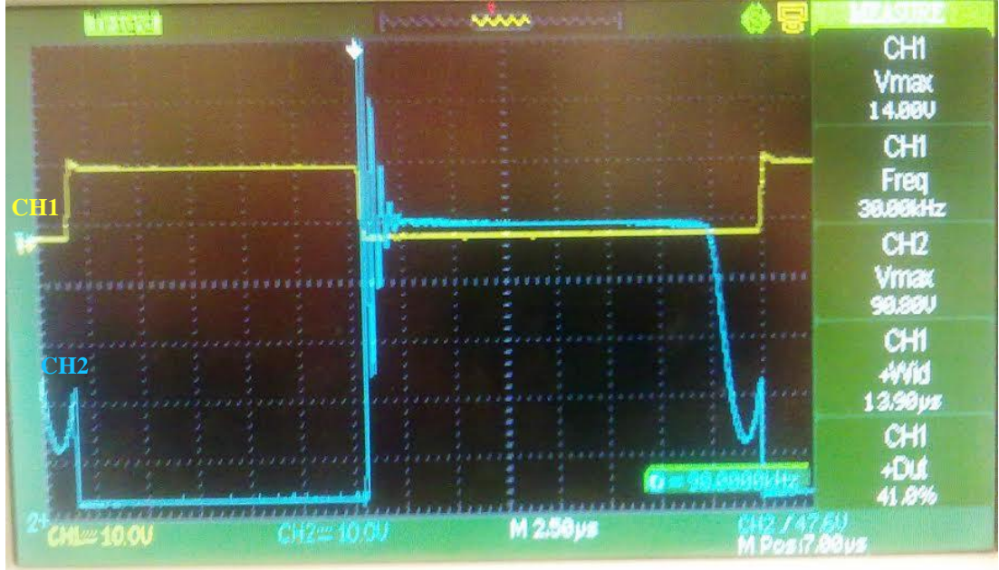
Şekil 4.56. Flyback konvertör devresinin osilaskop çıktısı(Sarı PWM sinyali, Mavi Vds voltajı).
