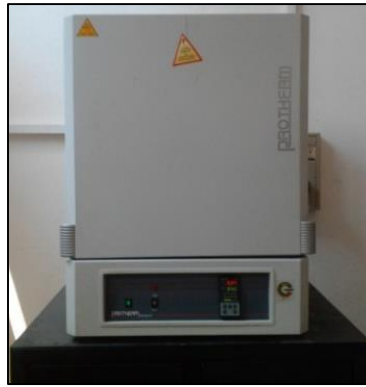
Şekil 3.7. T6 ısıl işlemi yapılan fırının görüntüsü.
