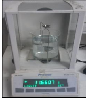
Şekil 3.13. Yoğunluk ölçüm kiti.
