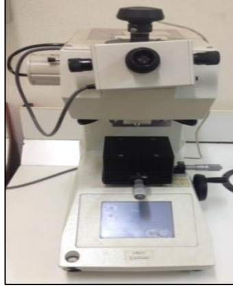
Şekil 3.14. Mikro sertlik cihazı.
