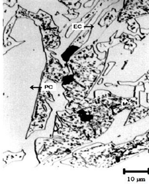
Şekil 2.1. YKBDD’in mikroyapısı; (PC: birincil karbürler, EC: ötektik karbürler, M: martenzit) [25].
