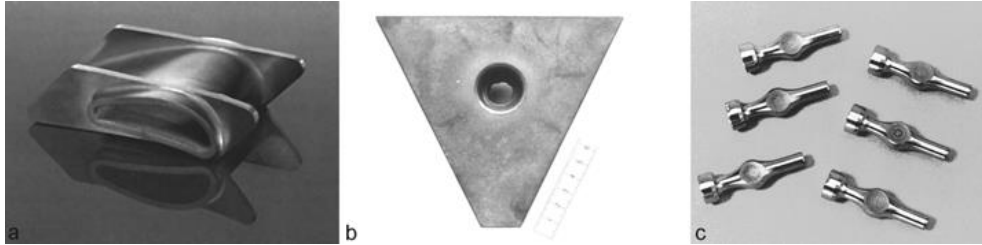
Şekil 2.13. NiAl-Cr alaşımdan yapılmış parçalar a) stator bıçak, b) termal blok ve c) enjeksiyon iğneleri [20].
