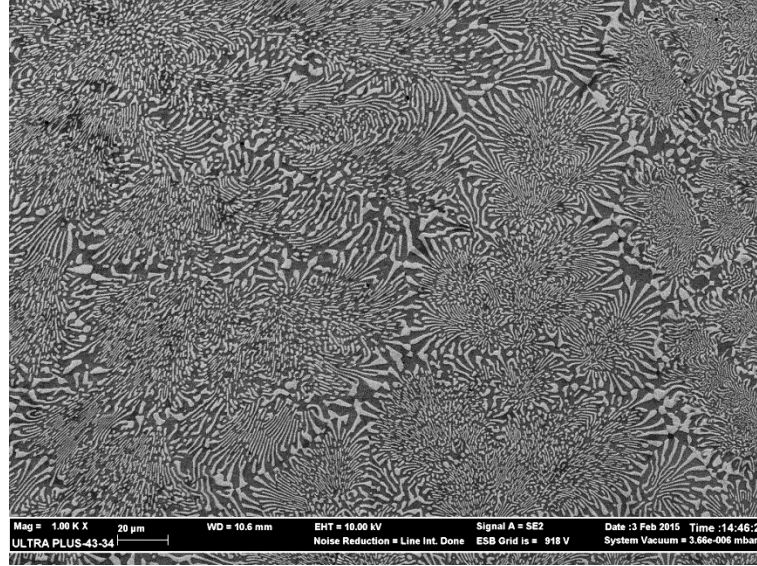
Şekil 4.20. NiAl-Cr(Mo)+0,5 Fe alařımının farklı dođrultudan mikroyapı grnts.
