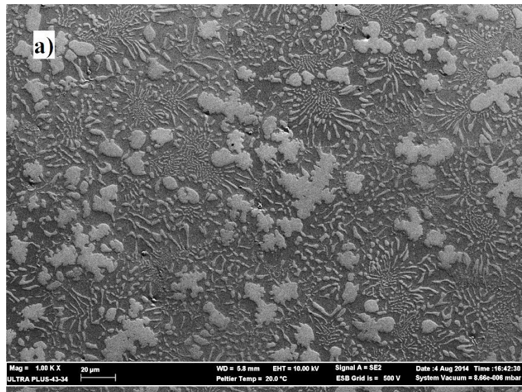
Şekil 4.34. NiAl-Cr(Mo)+6 Ti alaşımının a) ısıl işlem öncesi ve b) ısıl işlem sonrası mikroyapı görüntüleri.
