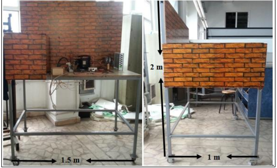
Şekil 4.2. Çevrime ait sistemin montajlandığı platform ve boyutları.
