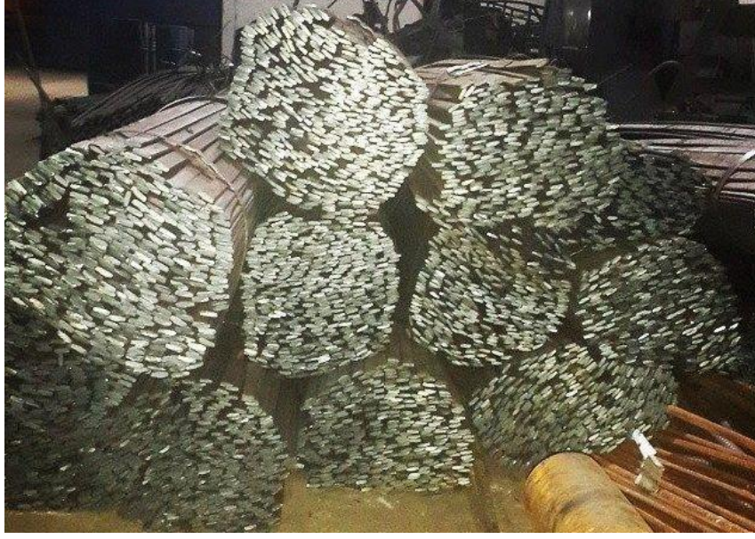
Şekil 4.5. Paketlenen çubuk demirlerin istiflenmesi.
