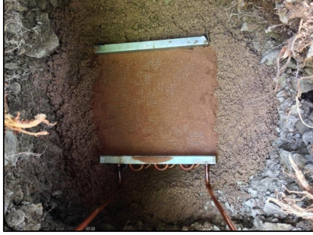
Şekil EK A. 7. Toprak altına gömülmüş olan kondenser ve silis kum.
