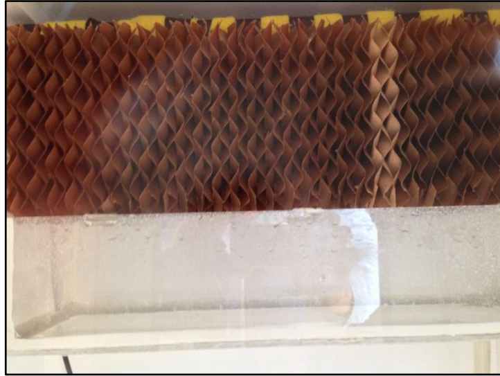
Şekil EK A. 4. Pad malzemesi.
