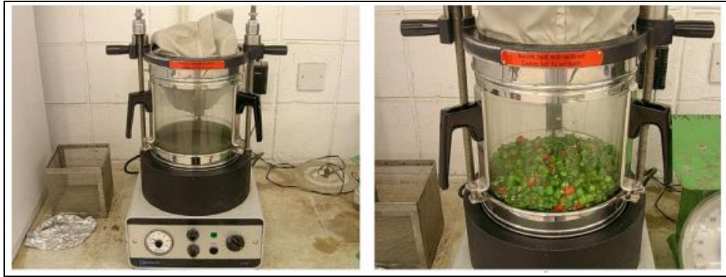
Şekil 2.11. Kuş biberlerinin kurutulmasında kullanılan AYK.
