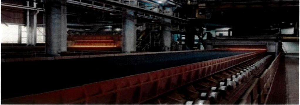
Şekil 2.3. Sinterleme sonunda şarjlama tesisi.
