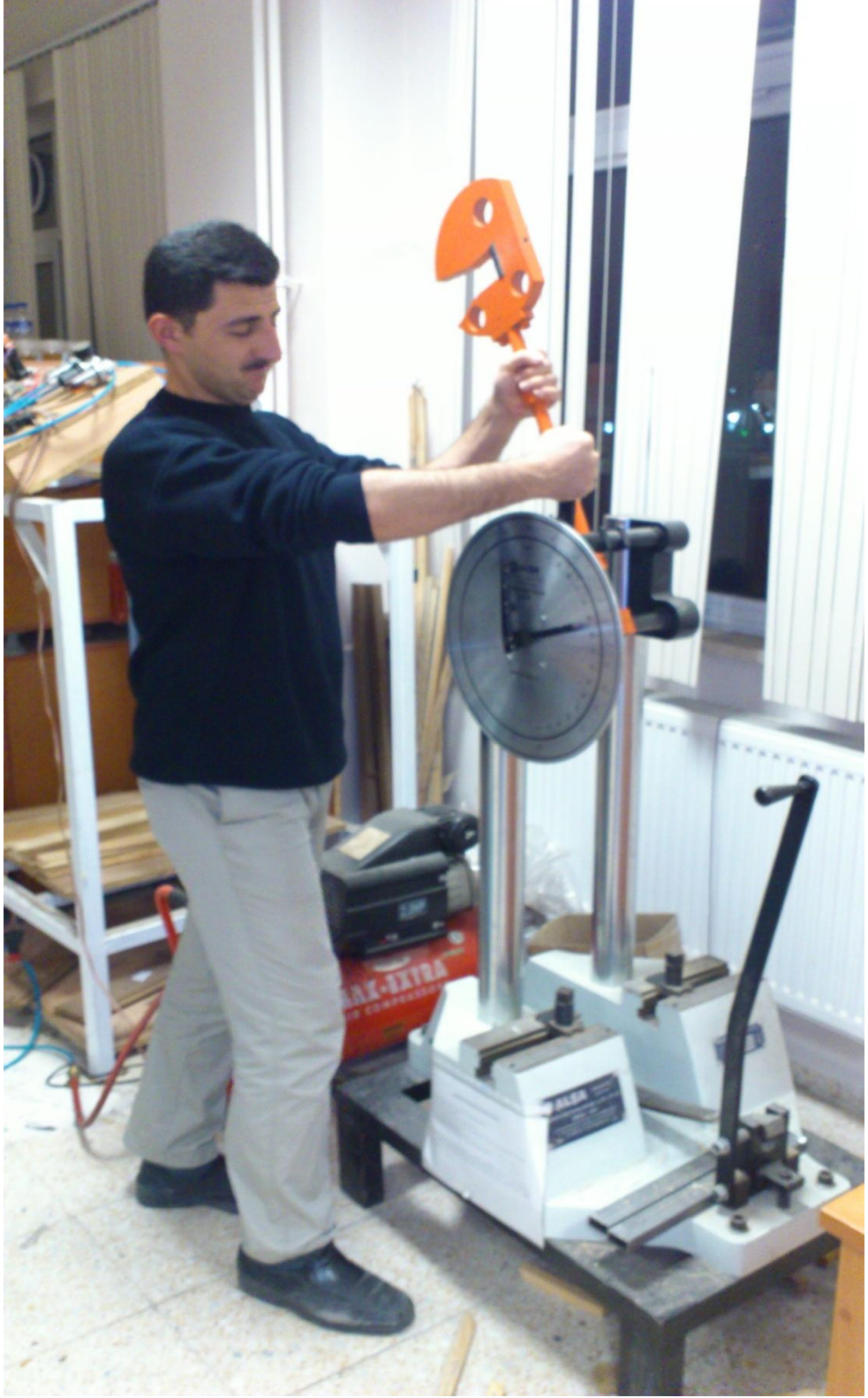
Şekil 3.8. Pandüllü çekiç makinesinde dinamik eğilme (şok) direnci.
