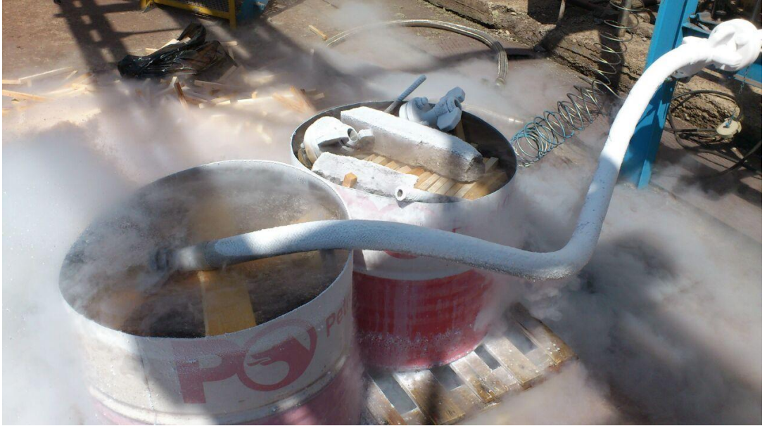
Şekil 3.4. Kardemir A.Ş. enerji tesislerinde deney numunelerinin sıvı azot'a tatbiki.
