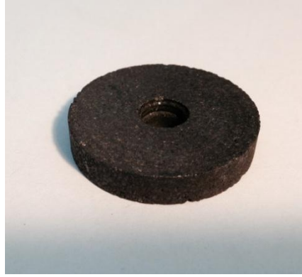
Şekil 5.4. Termal iletkenlik ölçümleri için kullanılan grafit numune tutucu.
