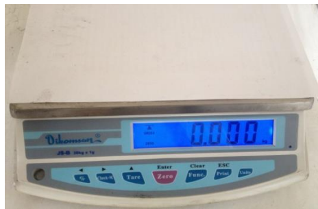
Şekil 5.10. Yakıt tüketimini ölçümünde kullanılan elektronik terazi.
