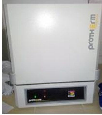
Şekil 6.4. Protherm marka ısıtma işlemi uygulanan fırın.
