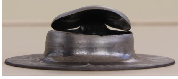
Sekil 3.4. Limit çekme oranının aşılmasıyla is parçasında meydana gelen hasar [20].
