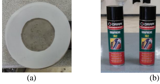
Şekil 4.15. a) Teflon film (0,3 mm) b) Graphite 702 (yağlayıcı).
