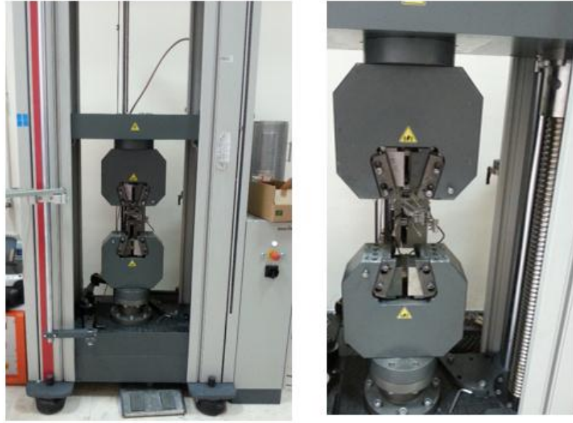
Şekil 4.16. Zwick Roell Z300, Tek eksen çekme test makinası, MŞMM.
