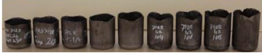
Şekil 5.16. HC300LA, t=1,2 mm sac malzemesine ait, WDD prosesiyle şekillendirilmiş kaplar.
