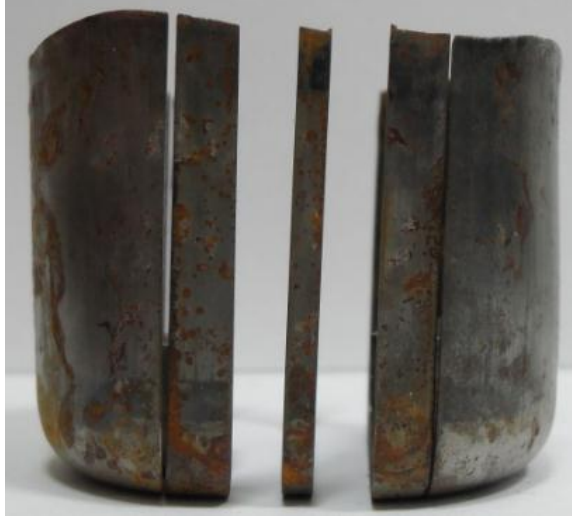
Şekil 5.38. Geri esneme ölçümü için kesilmiş örnek numune.
