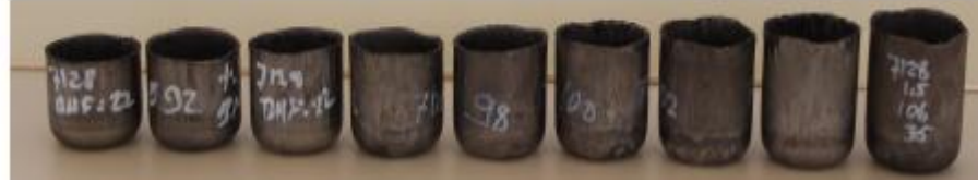
Şekil 5.17. HC300LA, t=1,5 mm sac malzemesine ait, WDD prosesiyle şekillendirilmiş kaplar.
