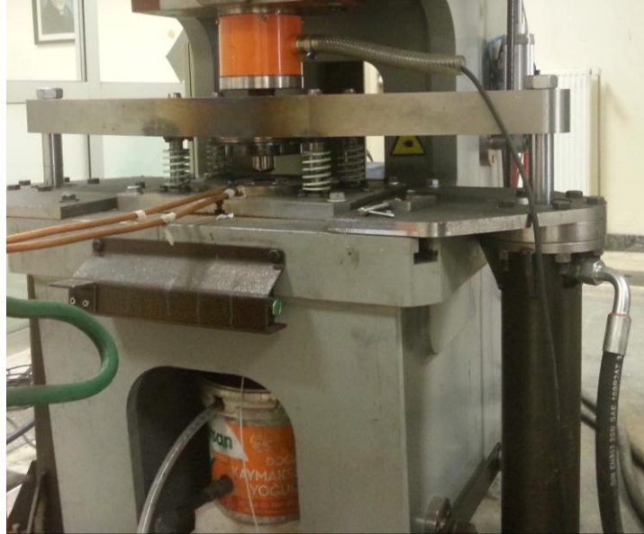
Şekil 4.5. Hidrolik baskı sistemi genel görünüş.
