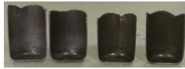
Şekil 5.34. Kalınlık ölçümü için kesilmiş deney numuneleri.
