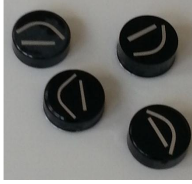
Şekil 4.21. OM görüntüsü ve sertlik ölçümü için bakalite gömülmüş test numuneleri
