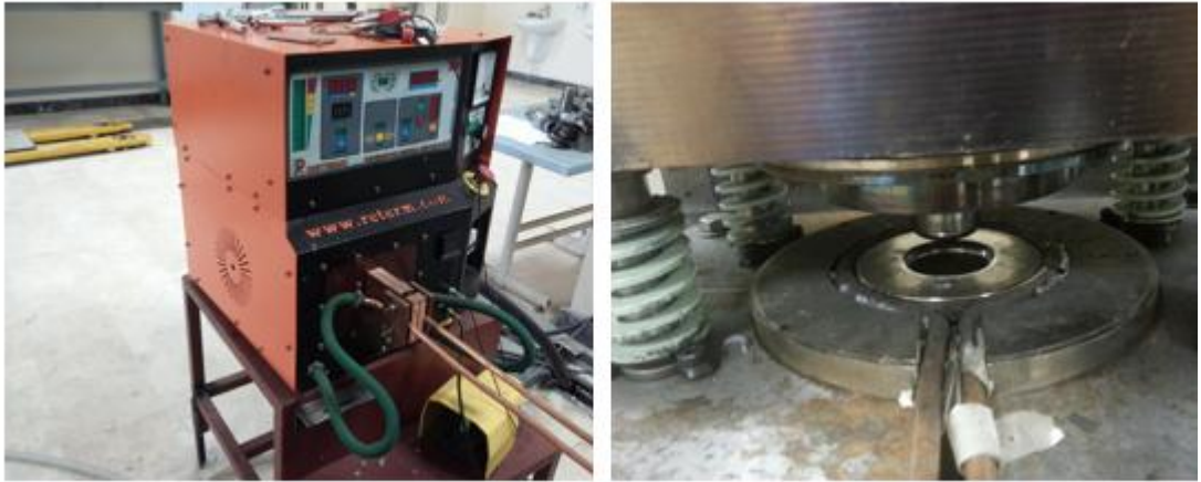
Şekil 4.6. İndüksiyon ısıtma makinası ve montajı.
